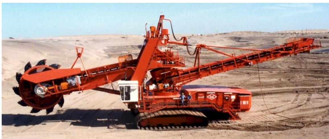
Слика 2.5 Конструкција стреле багера пуних зидова
