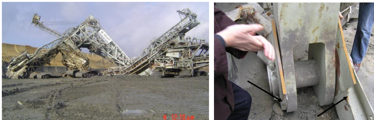
Слика 4.5 Хаварија багера SRs 1760 – РБ Колубара, Лазаревац [61]
