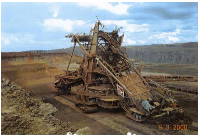
Слика 4.4 Хаварија багера SchRs 630 - ВНР Australia [60]
