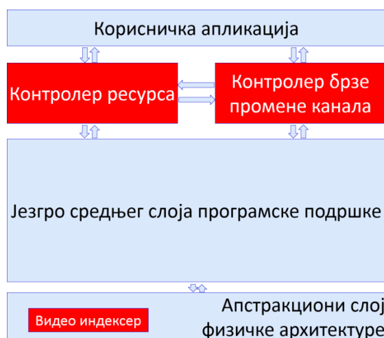
Слика 15. Архитектура програмске подршке дигиталног ТВ пријемника након увођења нових модула
