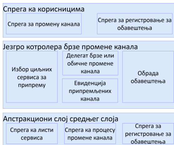
Слика 16. Архитектура програмске подршке контролера брзе промене канала
