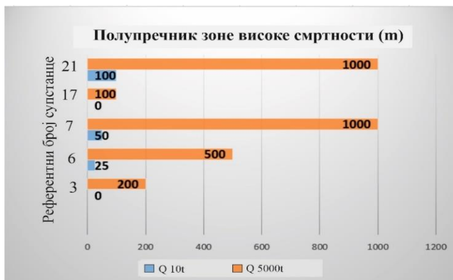
Слика 7.2. – Полупречник зоне високе смртности при испуштању 10t и 5000t органских растварача који су дефинисани референтним бројем опасне супстанце
