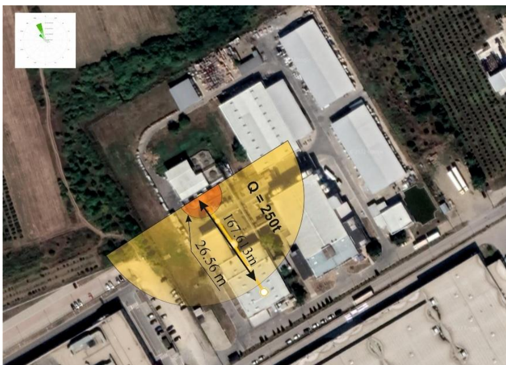
Слика 7.4. – Зона високе смртности (пребојена наранџастом бојом) и иреверзибилна зона (пребојена жутом бојом) при истицању 250t угљентетрахлотида у фабрици боје и лакова
