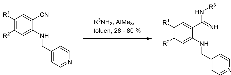
Šema 2.4.35. Sintaza monosupstituisanih amidina iz amina i nitrila pomoću AlMe 3
