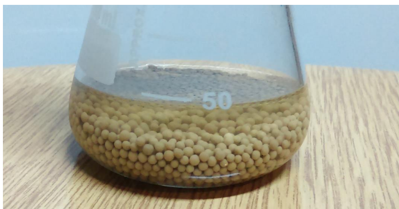
Slika 2.2.3. Sušenje tetrahidrofurana nad molekulskim sitima
