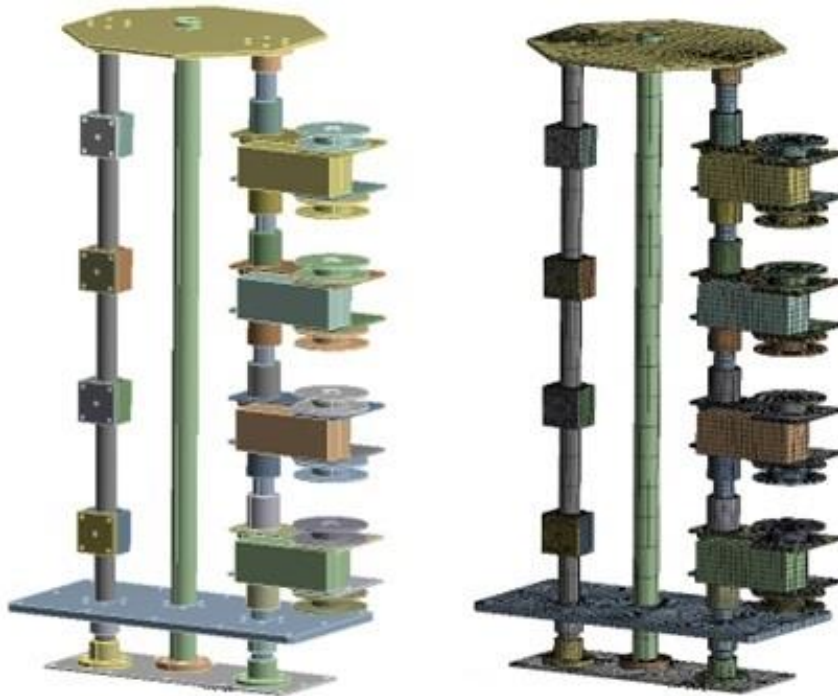
Слика 8.1 Упрошћени и дискретизовани геометријски модел вертикалног носећег стуба
