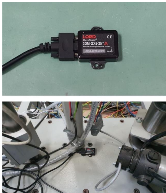
Слика 7.17 Инерцијална мерна јединица монтирана на средини роботске јединице
