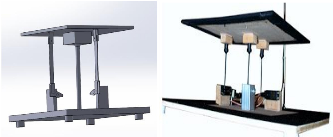
Слика 6.6 Подешавање нагиба са 2 линеарна актуатора [81]
