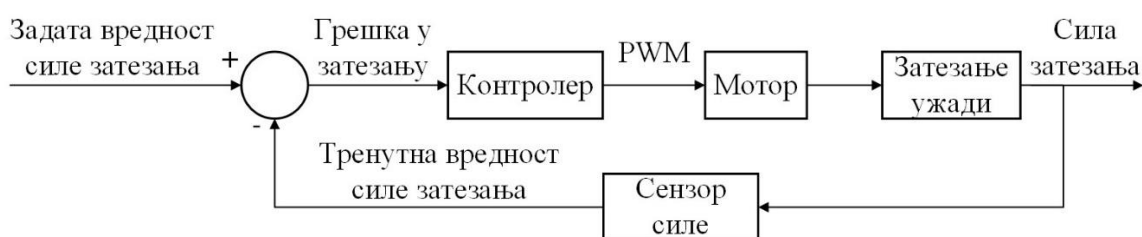
Слика 9.1 Блок дијаграм управљања подсистема за затезање ужета
