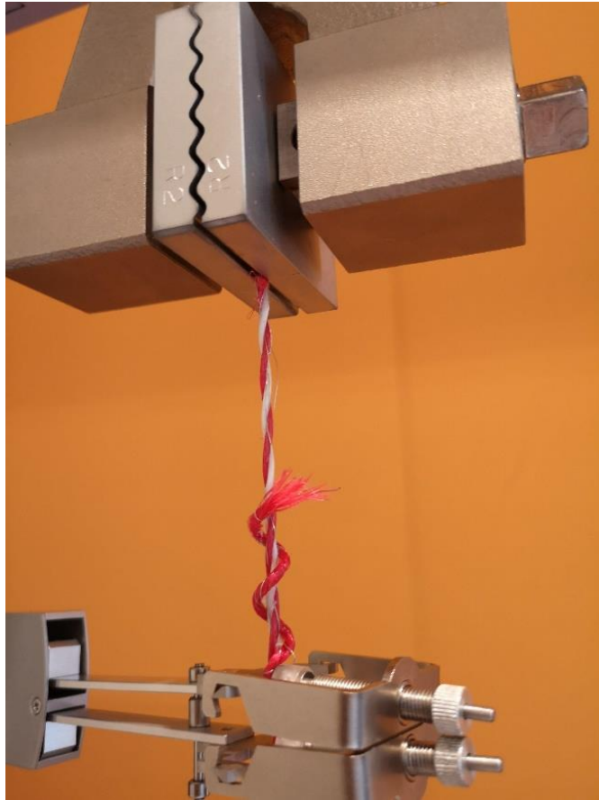
Слика 7.10 Тест бр.1 - Уже након пуцања
