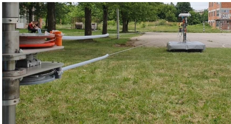
Слика 9.3 Испитивање управљања подсистема за затезање ужета у контролираним условима
