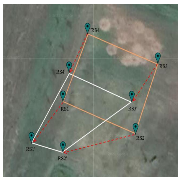
Слика 9.4 Почетна позиција и кретање роботских јединица
