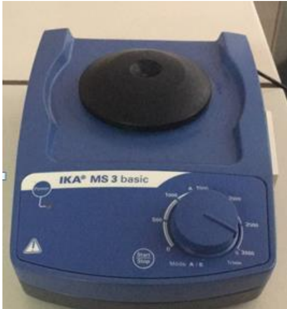
Slika 34. Vorteks za homogenizaciju reagenasa (Foto: Ivezić, 2017).
