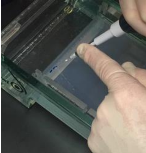
Slika 37. Komora za elektroforezu. i postavljanje PCR produkata u gel za elektroforezu (Foto: Ivezić, 2016).
