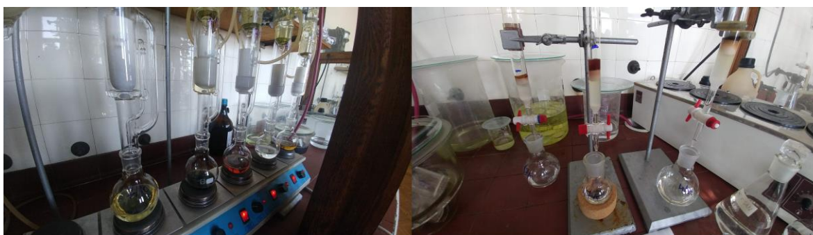
Slika 28. Aparatura za izvođenje ekstrakcije po Sokskletu ( levo ) i hromatografija na koloni nakon izolovanja bitumena ( desno ).
