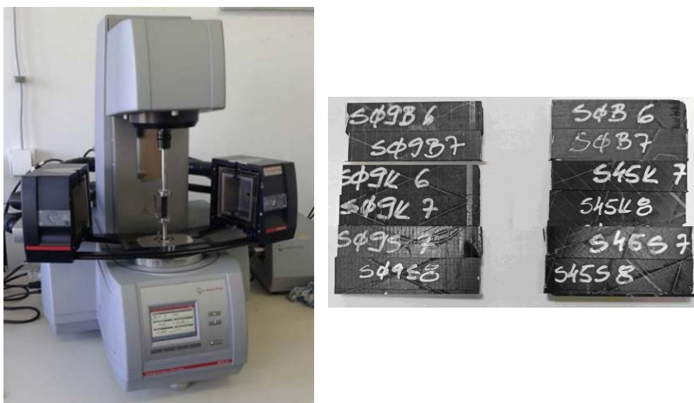
Слика 62. ДМТА уређај MCR-302 са узорком у клеммама и део узорака за испитивање
