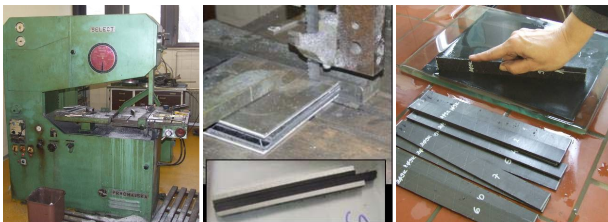
Слика 50. Сечење композита на тестери између плоча алуминијума и површинска обрада
