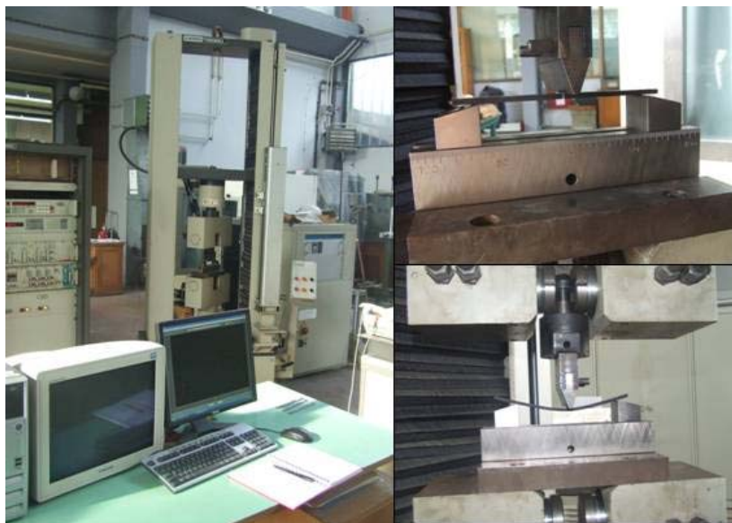
Слика 71. Испитивања на савијање на кидалици SCHENK TREBEL RM 100
