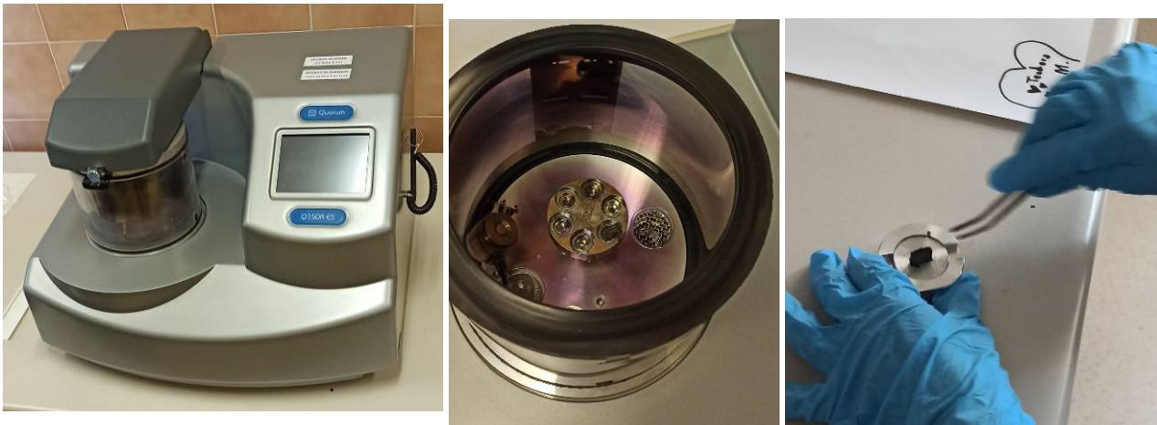
Слика 60. Уређај Quorum Q150R ES и стављање узорка на носач
