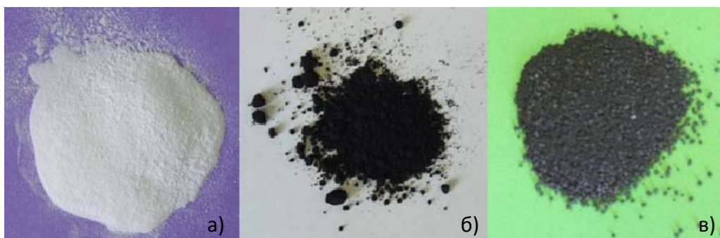
Слика 25. Узорци: а) ПББ, б) IF-WS 2 и в) INT-WS 2
