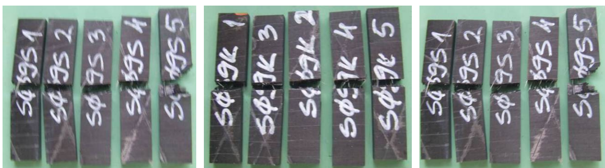
Слика 157. Епрувете препрег + ПВБ са и без наночестица оријентације 0°/90°, усправно и положено после испитивања
