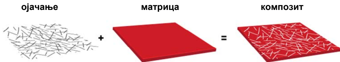
Слика 8. Основне компоненте композитног материјала [42]
