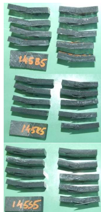
Слика 141. Упоредни дијаграм оптерећење-угиб препрег + ПВБ са и без наночестица оријентације ±45° и епрувете после испитивања
