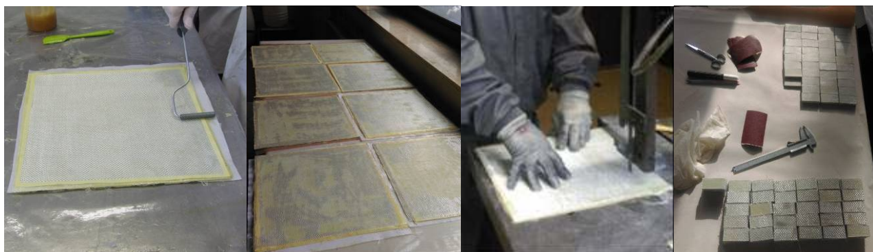
Слика 53. Фазе израде подметача за епрувете од стакленог платна
