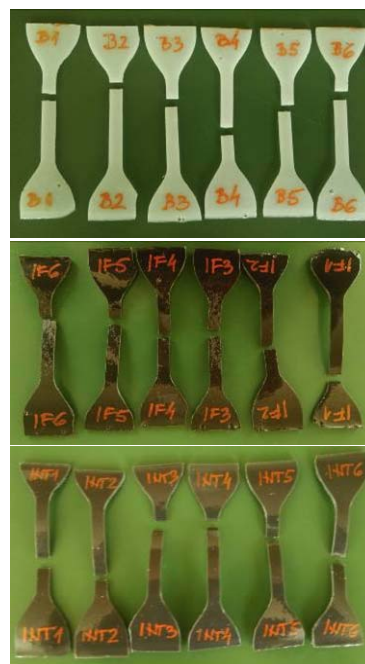
Слика 98. Упоредни дијаграм напон – деформација епрувета ПВБ/епокси смола са и без наночестица и епрувете после испитивања
