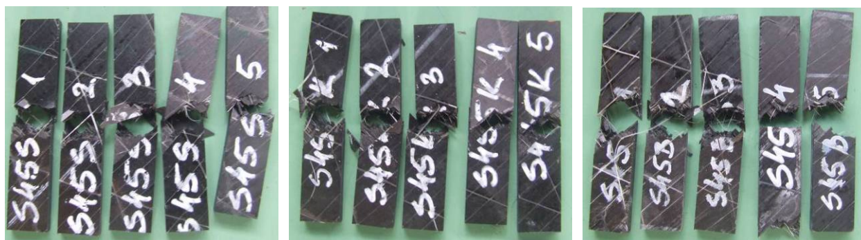
Слика 165. Епрувете препрег + ПВБ са и без наночестица оријентације \pm 45^\circ , усправно и положено, после испитивања
