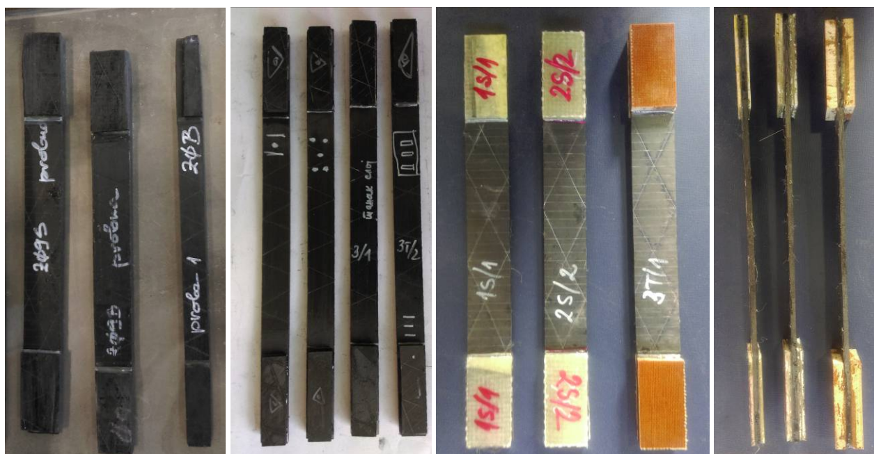
Слика 52. Пробна кидања епрувета са различитим подметачима и начинима лепљења
