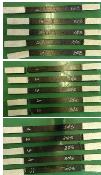
Слика 102. Упоредни дијаграм напон – деформација препрег + ПВБ са и без наночестица оријентације 0° и епрувете после испитивања
