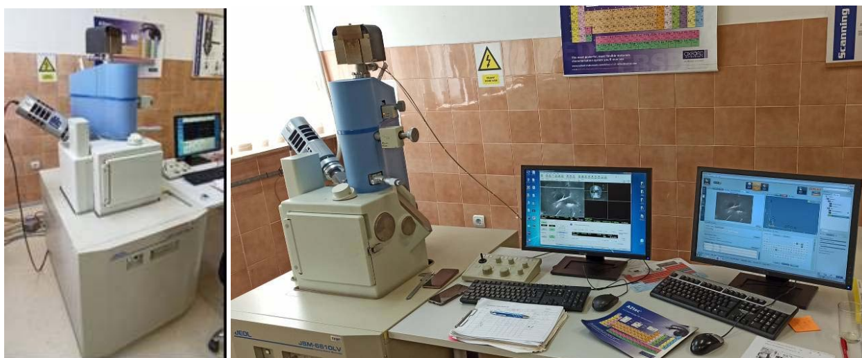
Слика 59. Скенирајући електронски микроскоп SEM JEOL JSM 6610LV са енергетско дисперзивним спектрометром OXFORD X-Max
