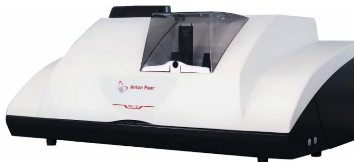
Слика 57. Ласерски дифракциони анализатор PSA 1190 LD, Anton Paar
