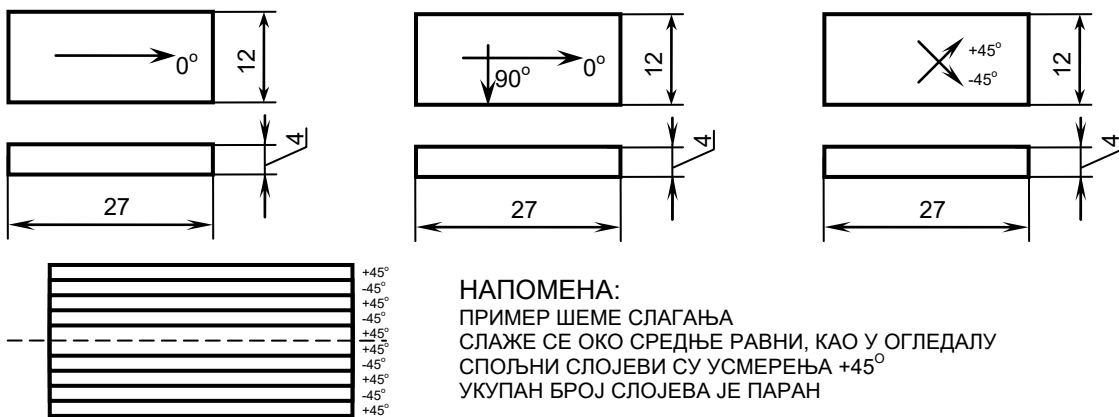
Слика 38. Епрувете композита за испитивање на интерламинарно смицање са усмерењима 0^\circ , 0^\circ/90^\circ и \pm 45^\circ према стандарду [59]
