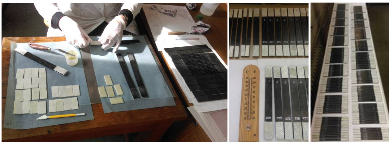
Слика 54. Фазе лепљења подметача на епрувете
