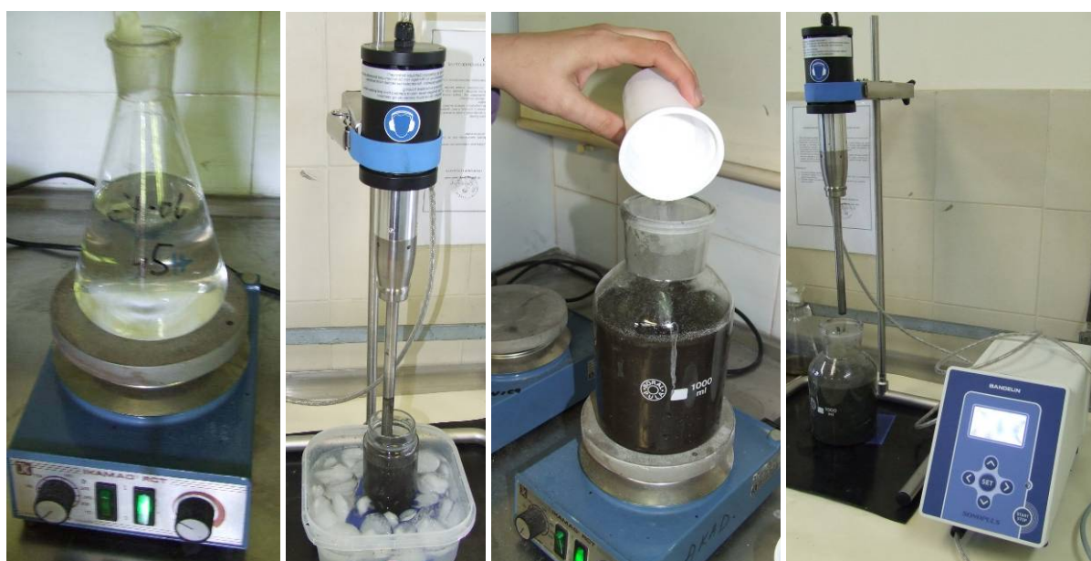
Слика 44. Припремање раствора без наночестица и са наночестицама
