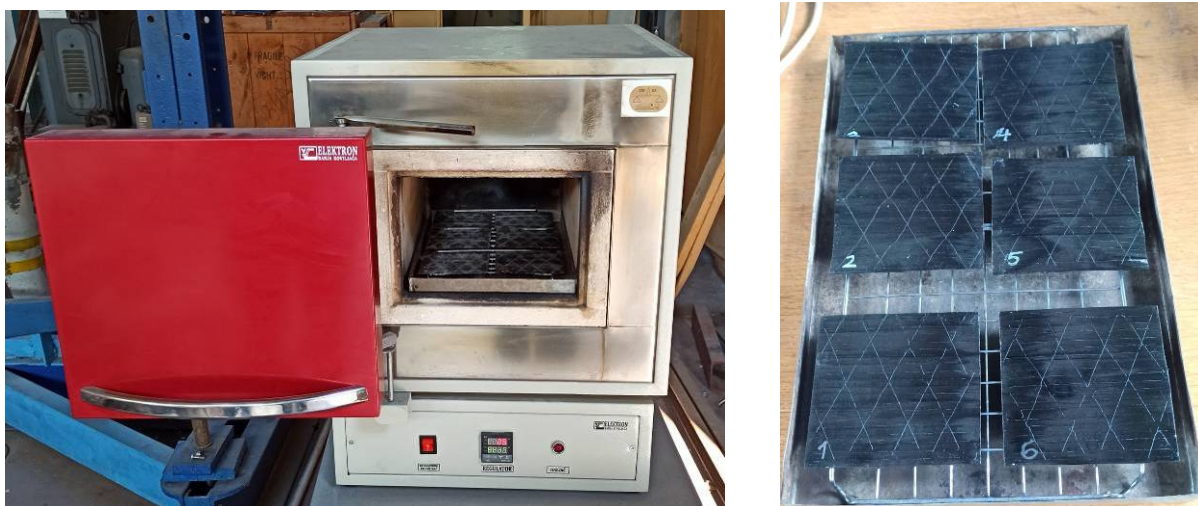
Слика 56. Пећ ELP-15 са узорцима и узорци после жарења
