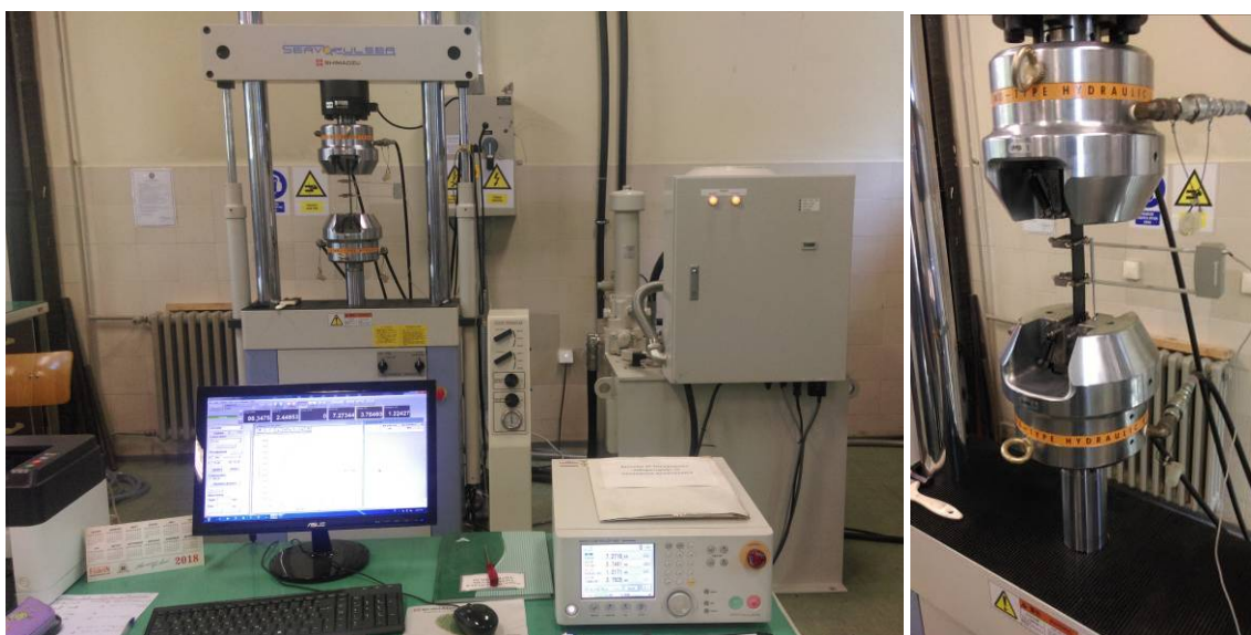
Слика 67. Испитивања на кидалици SHIMADZU SERVO PULSER
