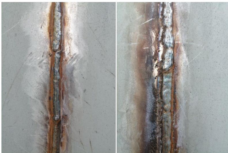
Slika 1.1: Višestruke greške izazvane nestabilnošću luka
