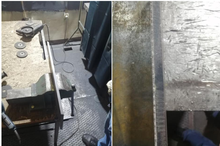
Slika 5.2: Priprema ploče za obradu brusilicom s leve strane i obrušena površina do metalnog sjaja sa desne
