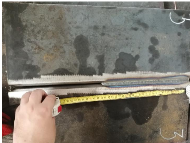
Slika 5.4: Mesto zastoja tokom zavarivanja
