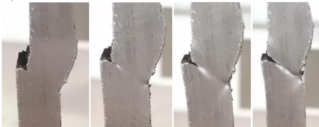
Slika 7.10: Različite faze loma epruveta za kombinaciju sa smaknućem i nadvišenjem [74]
