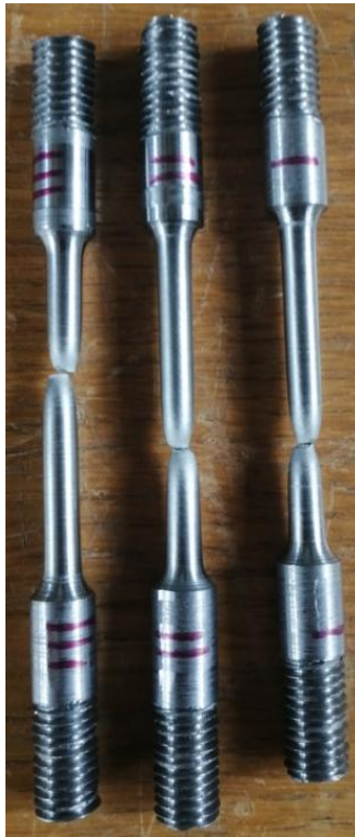
Slika 6.4: Izled epruveta nakon kidanja
