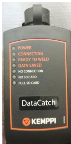
Slika 5.1: Uređaj za merenje parametara zavarivanja
