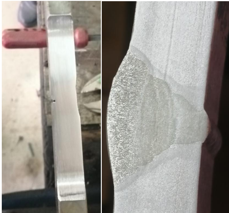
Slika 6.6: Izgled strukiranog dela epruvete gde se posle obrade brušenjem: levo) izgled strukiranog dela epruvete posle nagrizanja Nitalom; desno) izgled epruvete posle nagrizanja, na kojoj se jasno vide linija stapanja i zona uticaja toplote
