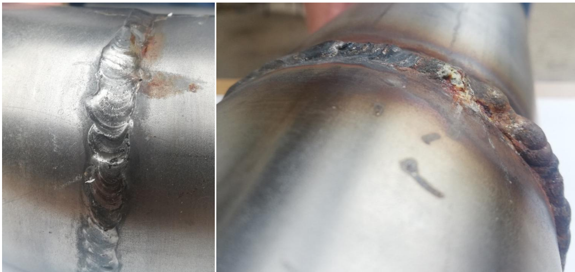
Slika 1.3 : Izgled višestrukih grešaka kod austenitnih cevi
