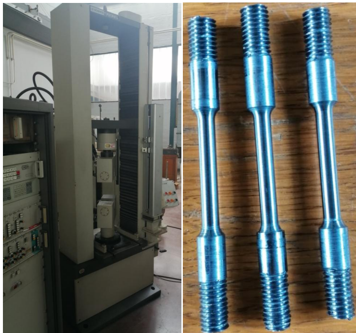
Slika 6.1: levo) INSTRON kidalica kapaciteta 250 kN; desno) epruvete za ispitivanje zatezanjem
