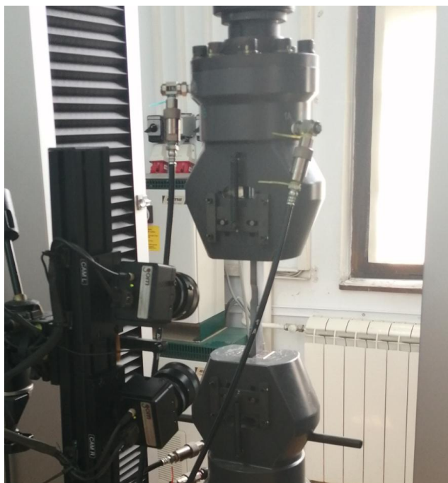
Slika 6.11: Izgled postavke DIC sistema na kidalici Shimadzu u laboratoriji TMF
