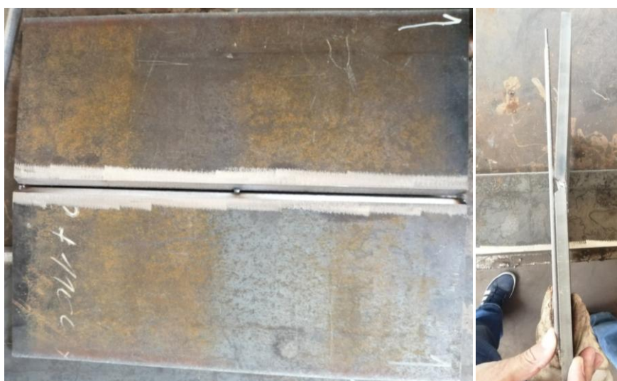
Slika 5.3: Pripoiji za zavarivanje na ploči 1 (levo) i izgled kontra nagiba (desno)
