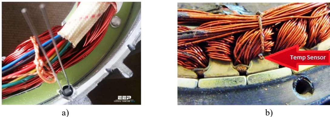
Slika 2.2 - Merenje temperature namotaja jedne faze: a) kontakt za pristup ručnom merenju; b) senzor za kontinualno bezkontrolno merenje temperature [11, 12]
