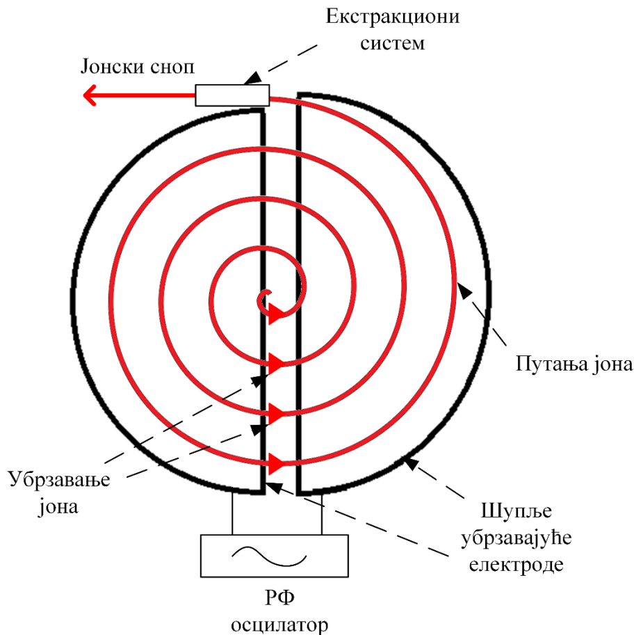
Слика 5. – Шема циклотронског акцелератора
