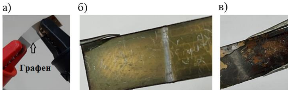
Слика 41: Фотографије а) графена добијеног помоћу ултразвучне кадице на савитљивој ПЕТ подлози, б) графена добијеног помоћу ултразвучне сонде на савитљивој ПЕТ подлози, в) електрохемијског графена на савитљивој ПЕТ подлози.
