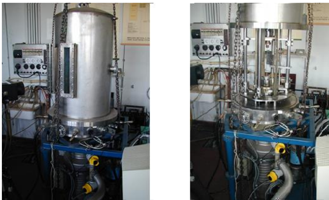
Сл. 15. Фотографије струјно импулсне поставке са спуштеним и подигнутим звоном у Институту „Винча“, преузето из [56]
