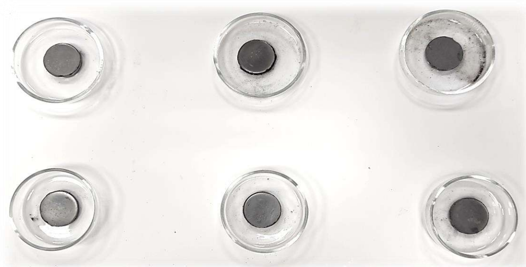
Слика 3.2.2 Пресоване пастиле калибрационих стандарда графита са различитим концентрацијама земље.
