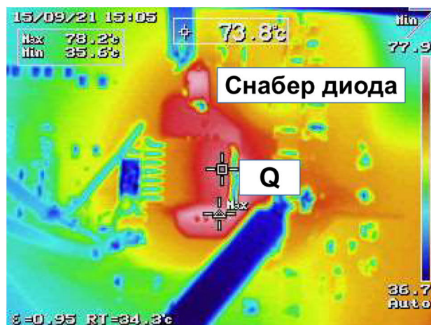
Слика 4.47 Расподјела температура код QRF претварача при пуном оптерећењу
