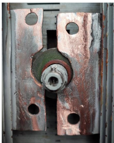
Слика 4.3: Изглед међуполне везе на којој се види траг пуцања
