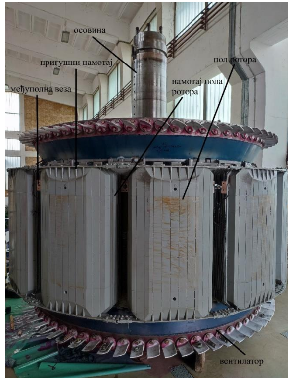
Слика 2.1: Најважнији елементи ротора хидрогенератора
