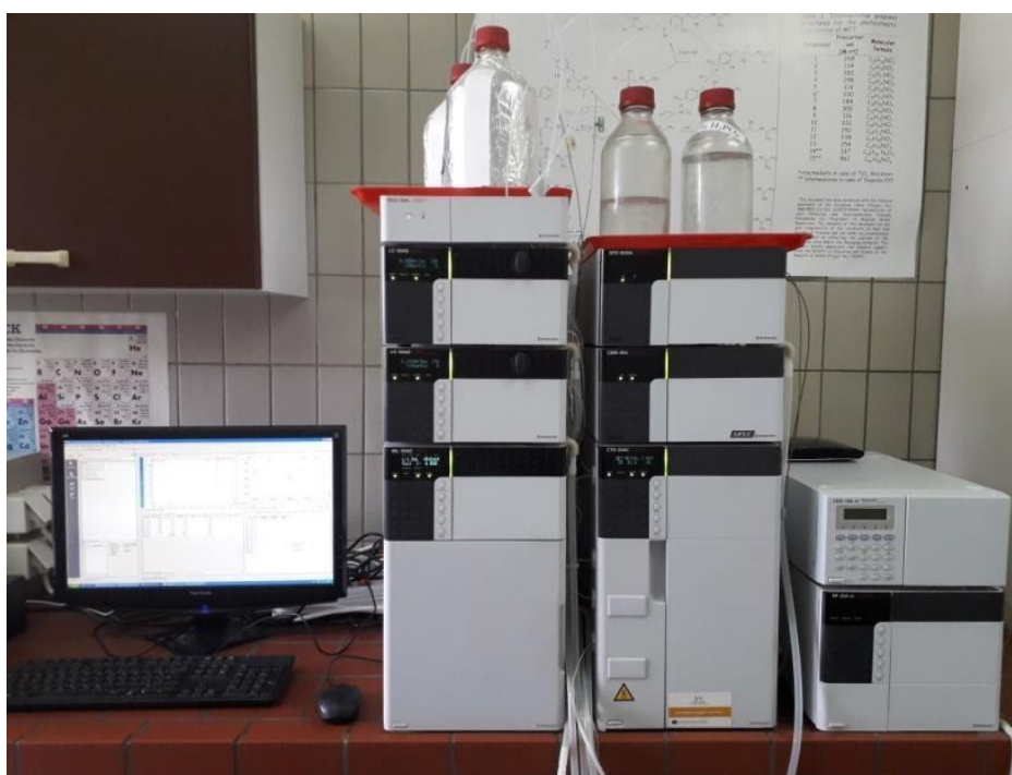
Slika 51. Tečni hromatograf Shimadzu HPLC sa UV/Vis DAD detektorom
