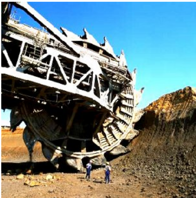
Слика 1.9. Радни точак D = 21.6 м, q = 6.6 м 3 , 18 ведрица (SchRs-6300, површински коп Hambach)
