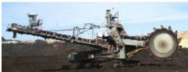
Слика 1.7. Конструкција стреле роторног багера: конструкција стреле пуних зидова и у облику решетке
