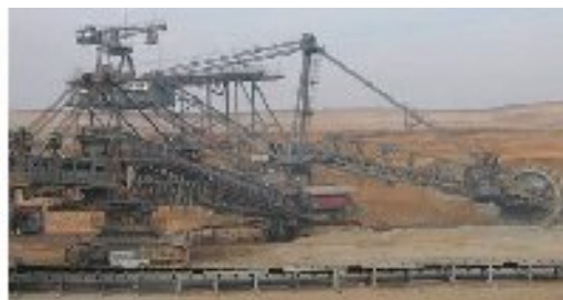
Слика 1.7. Конструкција стреле роторног багера: конструкција стреле пуних зидова и у облику решетке
