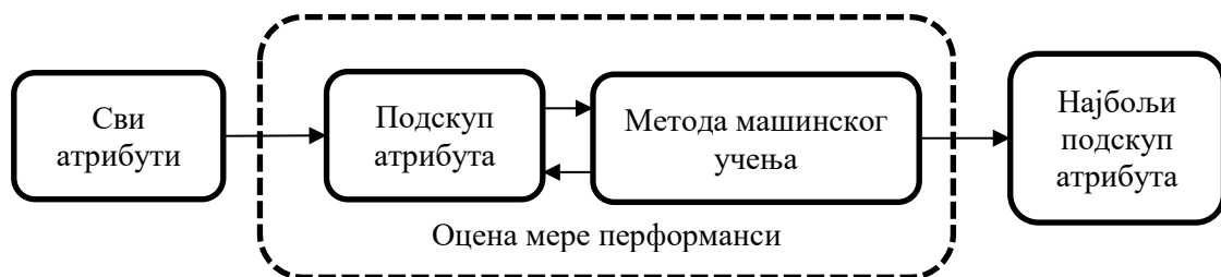
Слика 3.6: Принцип рада омотач–метода.
