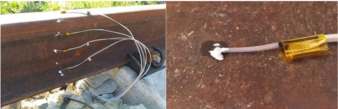
Slika 4.3 Montaža termistorskih senzora uz pomoć magneta
