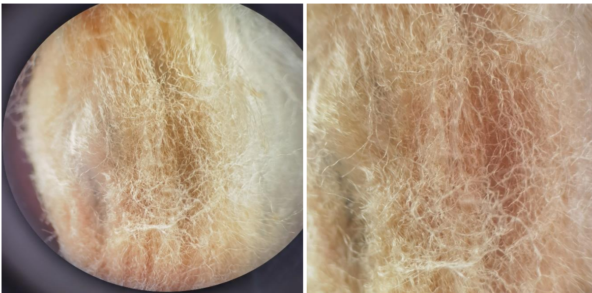
Slika 2. CA-vlakna korišćena u eksperimentalnoj studiji, dobijena iz upotrebljenih filtera cigareta.
