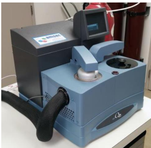
Slika 22. Uređaj TA Instruments DSC Q1000 (preuzeto iz [62])
