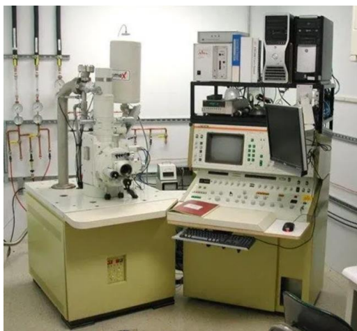
Slika 23. Skenirajući elektronski mikroskop JEOL JSM 840-A (preuzeto iz [63])
