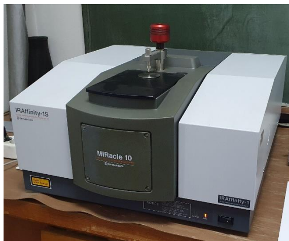
Slika 25. Uređaj Shimadzu IRAfinity-1s u ATR modu
