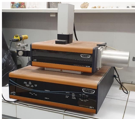
Slika 27. Uređaj za merenje toplotne difuzivnosti DLF-1200 TA Instruments
