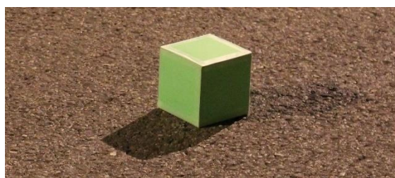
Слика 22. Светла коцка постављена на коловозу у зони придружене температуре боје 3000 K
