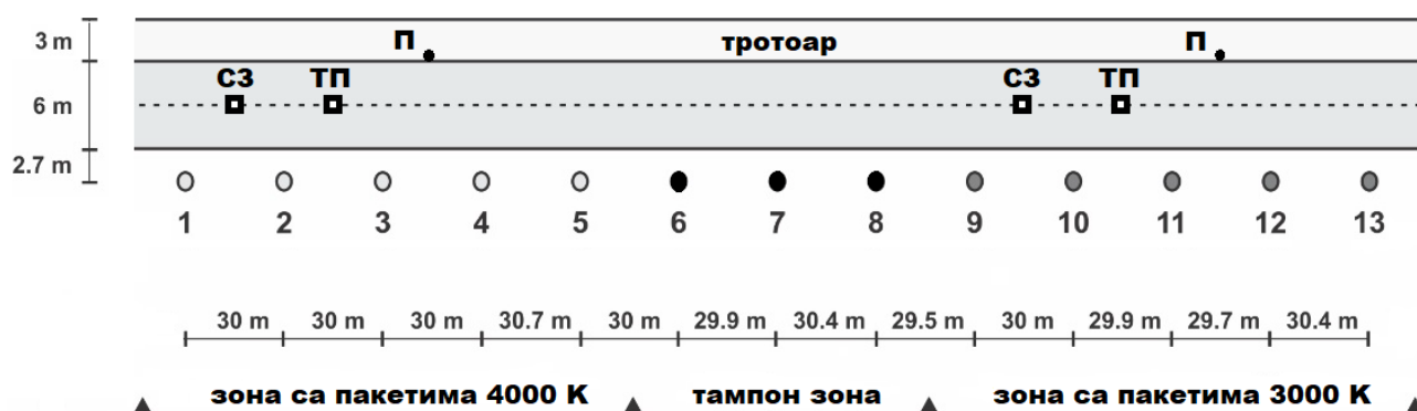
Слика 18. Геометрија улице са позицијама стубова и мета (П – пешаци, СЗ – светлозелена коцка и ТП – тамноплава коцка)
