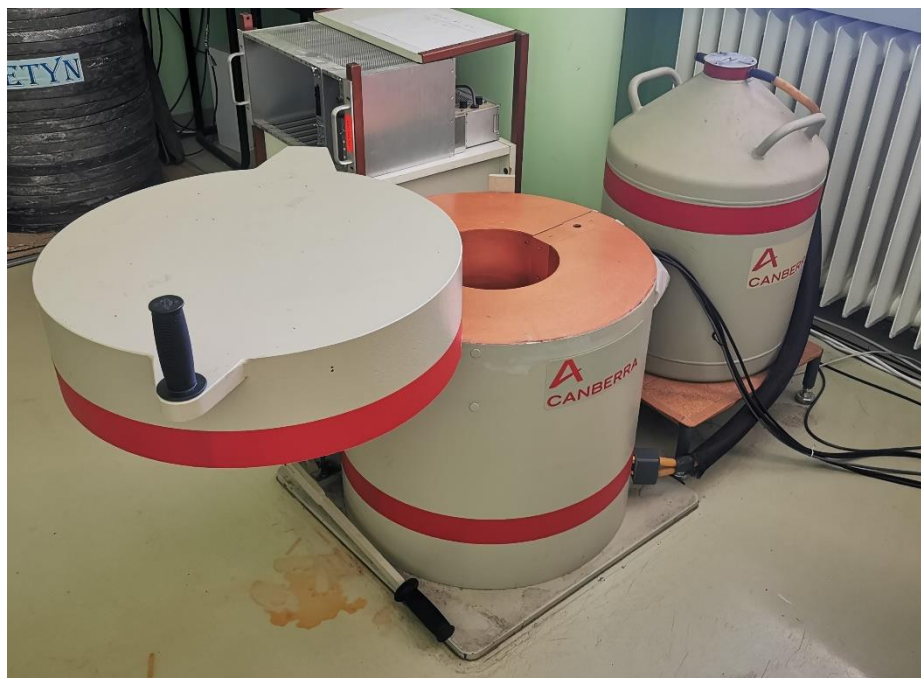
Слика 5.1. HPGe коаксијални детектор произвођача CANBERRA и серијске ознаке GX10021.
