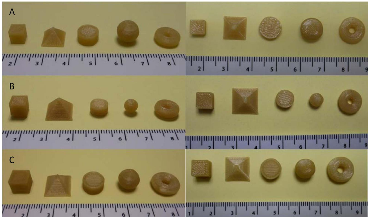
Slika 20. Slike 3DP proizvedenih tableta sa konstantnom (A) površinom, (B) odnosom površina/zapremina i (C) masom (skala bar u cm). Preuzeto iz (Goyanes i sar., 2015b)
