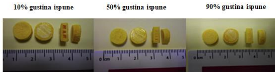
Slika 18. Izgled 3DP tableta sa različitim procentom punjenja (s leva na desno; pogled odozgo, osnova, unutrašnji i bočni) (preuzeto i prilagođeno iz Goyanes i sar., 2014)
