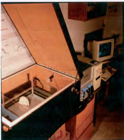
Slika 14. Uređaj za registraciju motorne aktivnosti životinja
