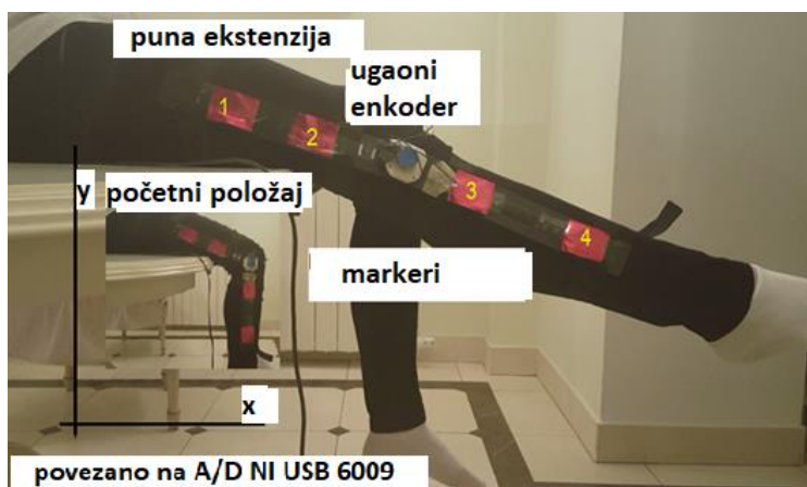
Slika 3. 3. Prikaz položaja markera i instrumenta sa ugaonim enkoderom postavljenim na dve lake poluge koje su pričvršćene na potkoleno i natkoleno. Slika pokazuje konačni položaj (potkoleno vertikalno) i početni položaj potkolena (noga opružena). Preuzeto i modifikovano iz [27].
