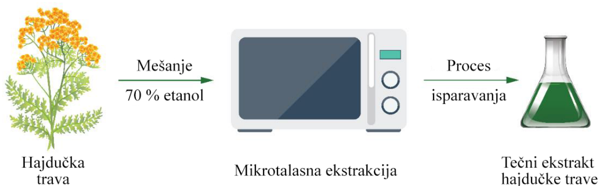
Slika 4.1. Šema procesa dobijanja tečnog ekstrakta hajdučke trave
