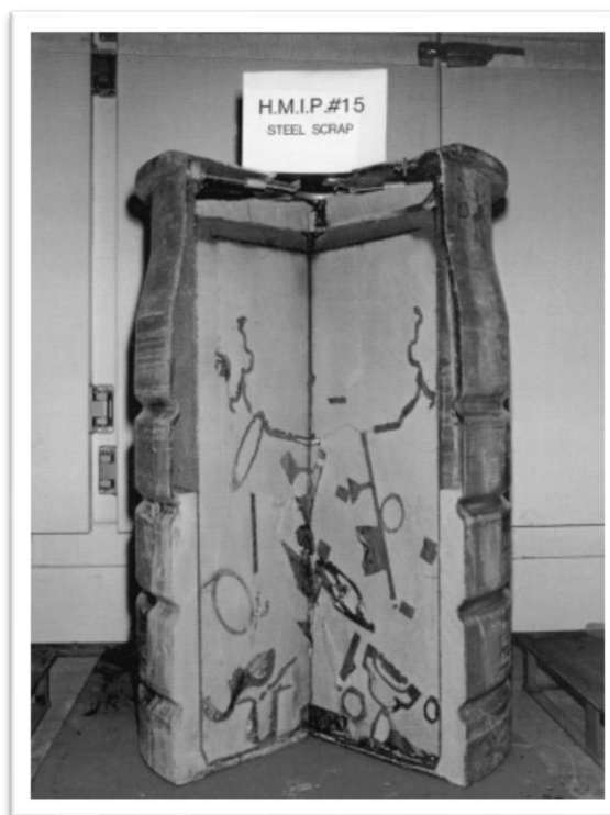
Слика 4.10. Чврст, метални радиоактивни отпад уграђен у цементну матрицу. [139]
