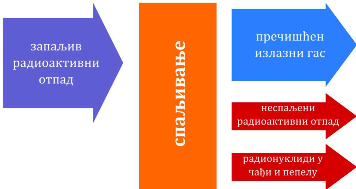
Слика 4.9. Схематски приказ спаљивања радиоактивног отпада.
