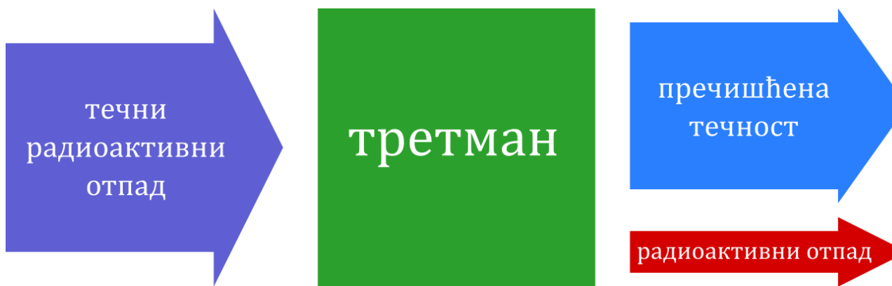
Слика 4.7. Третман течног радиоактивног отпада.
