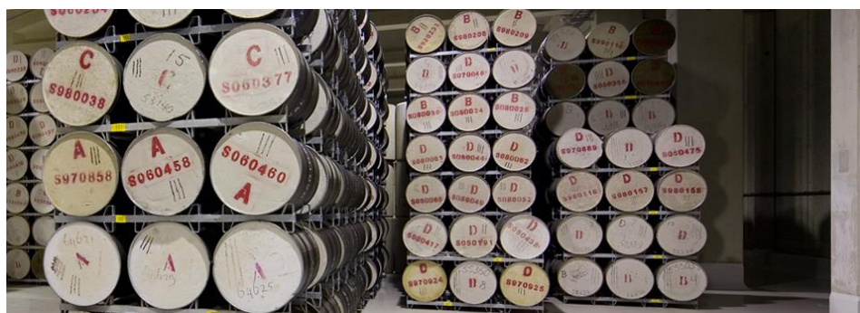
Слика 4.14. Најчешћи начини слагања различитих типова контејнера са радиоактивним отпадом у складишту.
