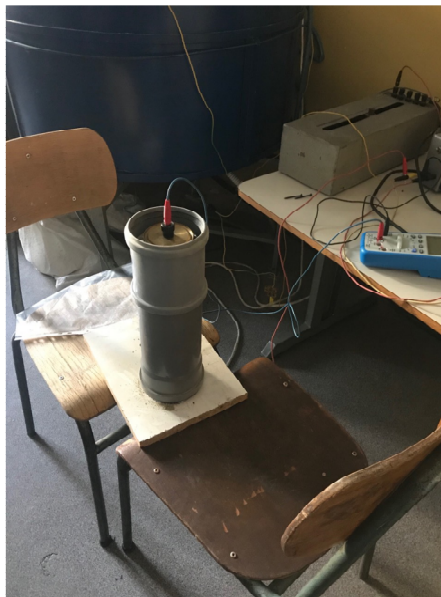
Сл. 8.10: Мерење специфичног отпора тла
