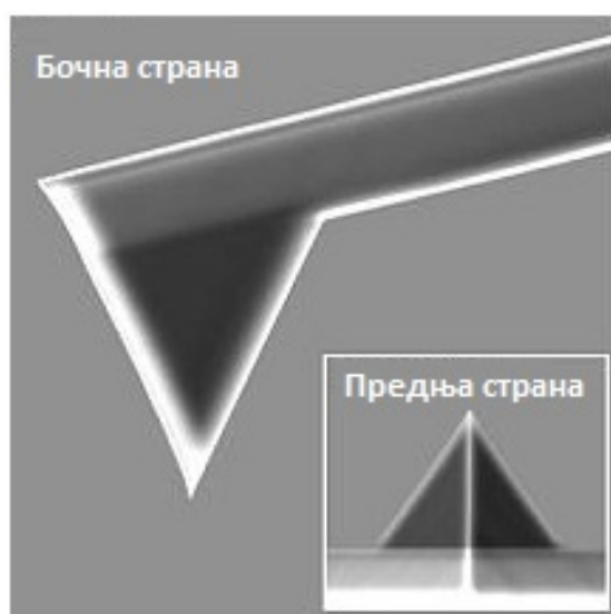
Слика 4.2. SEM слика врха сонде AFM система (преузето и адаптирано са https://www.nanoworld.com/electrostatic-force-microscopy-afm-tip-arrow-efm ).
