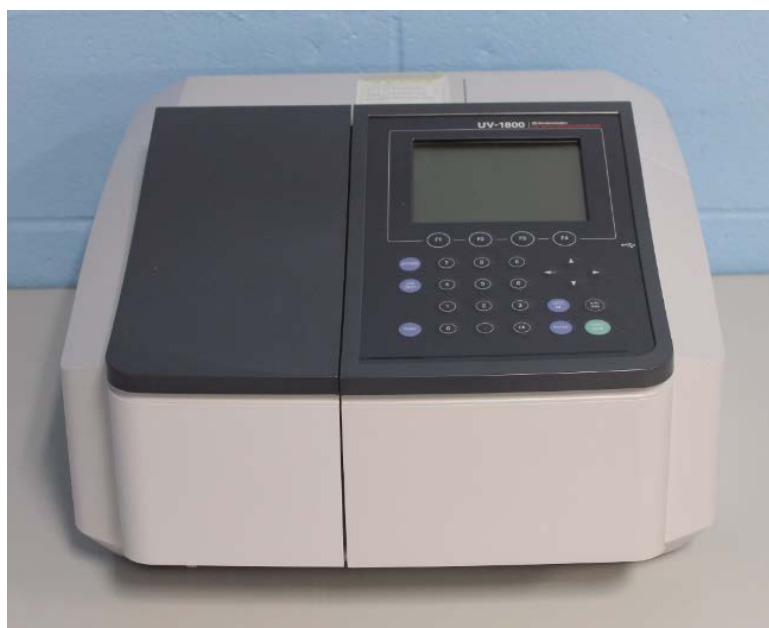
Слика 5.18. UV-Vis спектрофотометар, Shimadzu UV-1800
