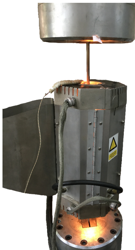
Слика А.4 Испитивање епрувете на затезање на повишеној температури
