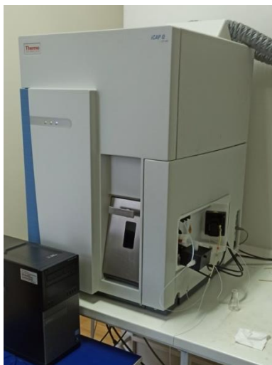
Slika 9. ICP-QMS: Indukovano kuplovana plazma sa kvadrupolnom masenom spektrometrijom; iCAP Q, Thermo Scientific X serije 2.
