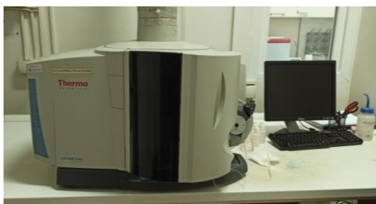
Slika 8. ICP-OES - Induktivno kuplovana plazma – optičko emisiona spektrometrija; model 6500 Duo; opremljen detektorom tipa CID86; Thermo Scientific Valtham, SAD.
