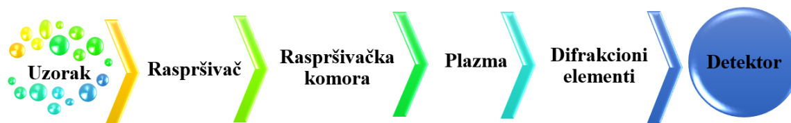
Slika 3.20. Osnovni delovi ICP optičkog emisionog spektrometra
