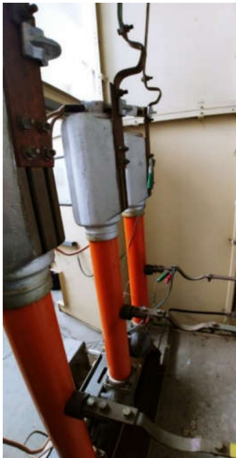
Slika 8.2 Postupak merenja padova napona na 35 kV prekidaču – veza priključnih krajeva
