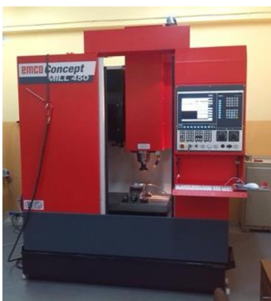
Слика 4.5. Троосни обрадни центар EMCO MILL 450
