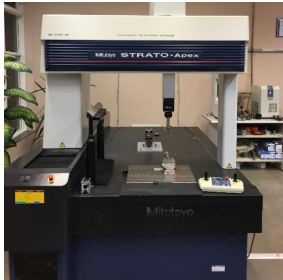
Слика 4.16. КММ Mitutoyo Strato – APEX 9166
