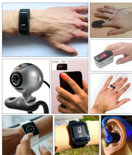
Slika 6. Komercijalni i medicinski uređaji koji koriste metod fotopletizmografije u cilju detektovanja talasnog oblika arterijskog protoka krvi (pametni satovi, narukvice, telefoni, prstenje i pulsni oksimetar) (Preuzeto i prevedeno iz Charlton et al. (2022))
