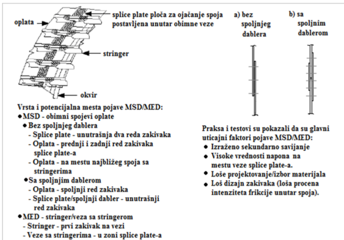
Sl.32. Veze stringera i sučeonih spojeva (MSD/MED) [27]
