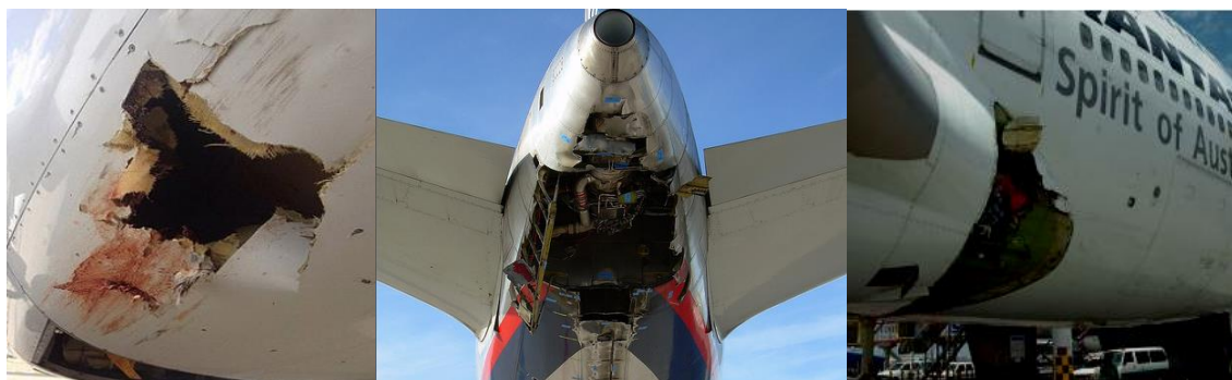
Sl.54. Primeri oštećenja strukture izazvani: Udarom ptica, udarom o pistu (tailstrike) i eksplozijom tanka za kiseonik [123, 122, 202]
