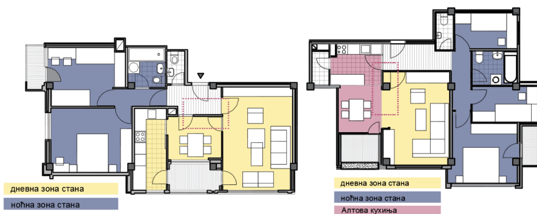
Слика 105. Основа стана (1977), угао Б. Немањића и Сремске, Ниш, арх. Д. Вељковић Слика 106. Основа стана, Ламела А 1-2 (1978), ул. Благоја Паровића 2, Ниш, арх. П. Катанић (Извор: Историјски архив Ниш, ауторов приказ према оригиналном пројекту)
