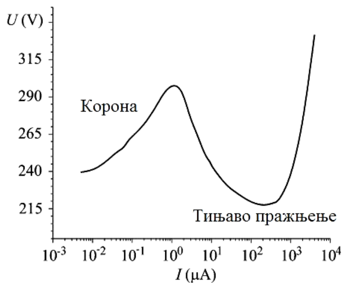
Слика 2.4. Волт-амперна карактеристика гасне диоде.
