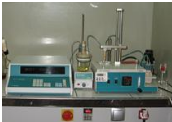
Slika 3.2.2 Karl Fischer Metrohm kulometar 737 KF sa 832 KF termoprepom – uređaj za merenje sadržaja vode u papiru i presbordu
