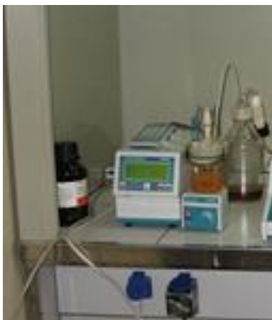
Slika 3.2.1. Karl Fischer Metrohm kulometar 831 - uređaj za merenje sadržaja vode u ulju
