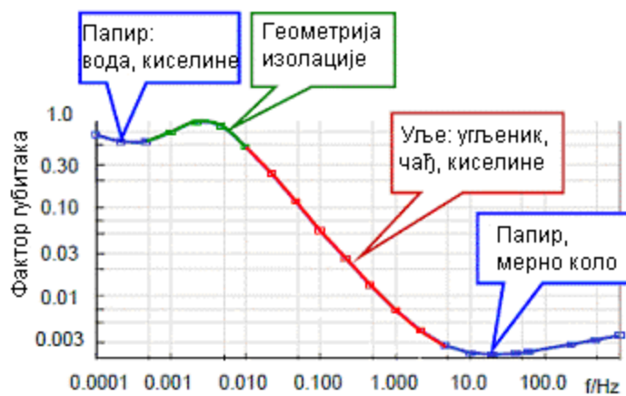
Slika 3.2.9 Faktor dielektričnih gubitaka izolacije zajedno sa efektom međupovršinske polarizacije (geometrija izolacije) i uticaj određenih polarnih produkata i nečistoća na dielektrične gubitke u različitim opsezima frekvencija prikazan za sadržaj vlage u čvrstoj izolaciji od 1%
