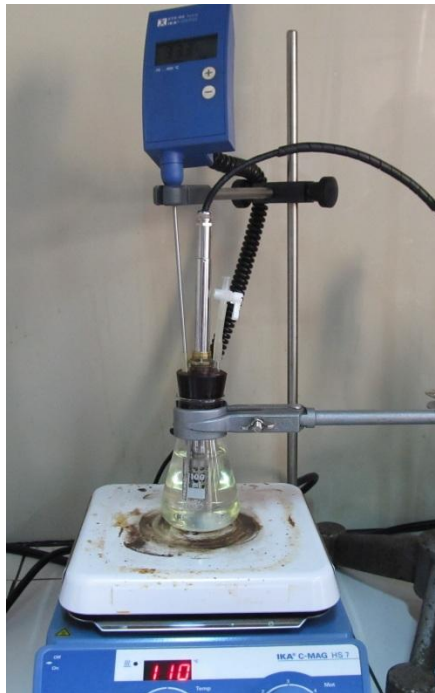
Slika 4.1.4 Aparatura za merenje RS ulja na željenoj temperaturi
