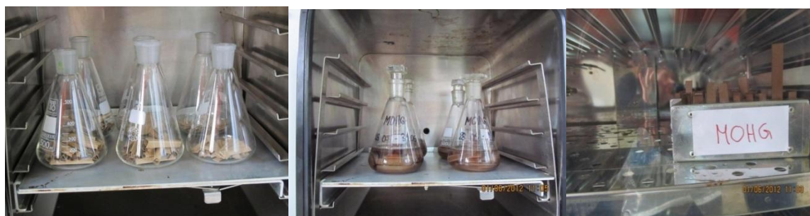
Slika 3.3.1 Priprema materijala za eksperiment: levo – sušenje papira i presborda, sredina - impregnacija, desno - vlaženje papira i presborda u vlažnoj komori
