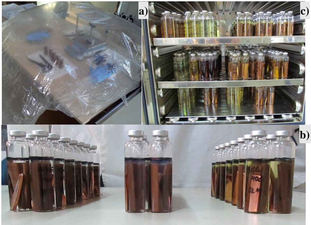
Slika 3.3.4. a) - Priprema materijala u "glove box"-u, b – pripremljene vijale sa izolacionim materijalima, c – uspostavljanje ravnotežne vlage u vijalama na određenoj temperaturi u pećnici
