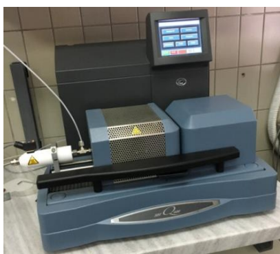
Slika 3.11. a) TG/DSC termogravimetrijski analizator SDT Q600 ; b) DSC Q20 diferencijalni termalni analizator.
