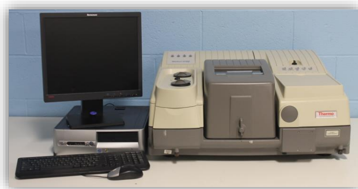
Slika 3.9. Aparatura za snimanje spektara u IC oblasti ( Thermo-Nicolet Nexus 670 ).
