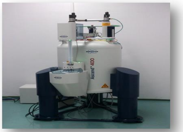
Slika 3.10. Bruker Advance III 400 MHz spektrometar.
