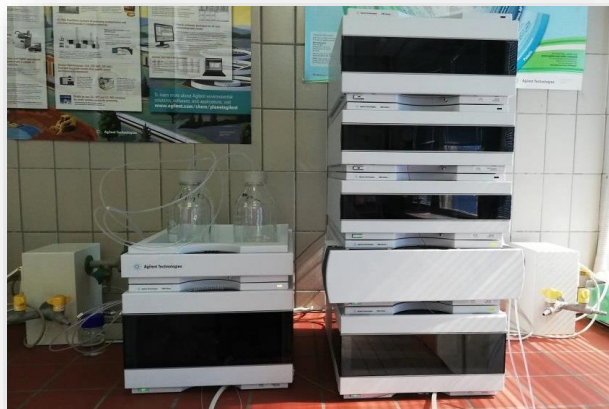
Slika 3.13. Izgled uređaja Agilent 1290 Infinity sa DAD detektorom.
