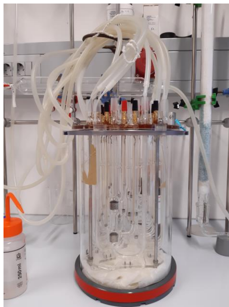
Slika 3.7. Set od devet ćelija za merenje provodljivosti razblaženih vodenih rastvora.
