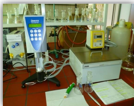
Slika 3.6. Aparatura za merenje viskoznosti tečnosti visokih vrednosti viskoznosti.
