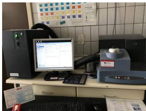
Slika 3.11. a) TG/DSC termogravimetrijski analizator SDT Q600 ; b) DSC Q20 diferencijalni termalni analizator.
