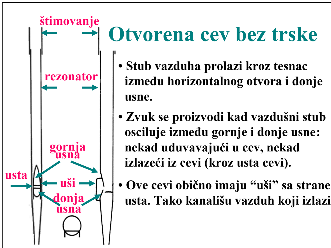
Slika 3.2.21.2: Šematski prikaz otvorene cevi orgulja, bez trske
