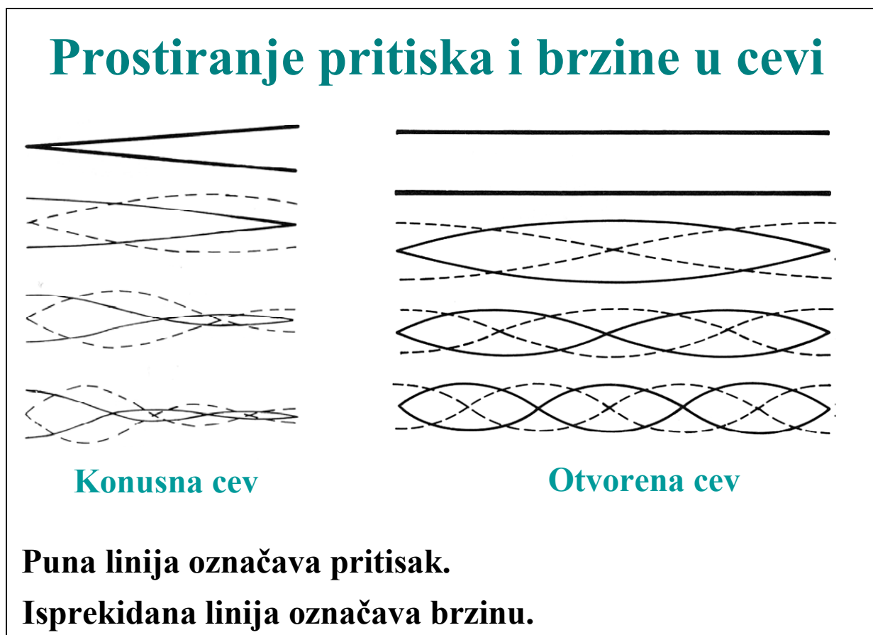
Slika 1.4.1: Prostiranje pritiska i brzine u cevi
