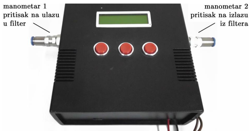
Slika 16. Integrisani uređaj za daljinski nadzor pada pritiska na filterima vazduha pod pritiskom sa upotrebom dva manometra
