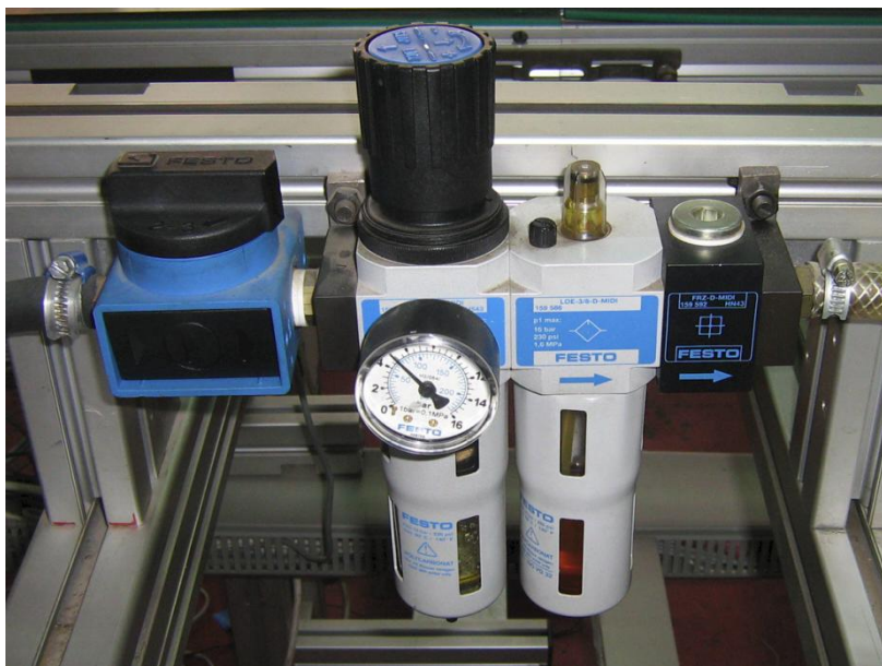
Slika 40. Mesto uzorkovanja kondenzata iz sistema vazduha pod pritiskom
