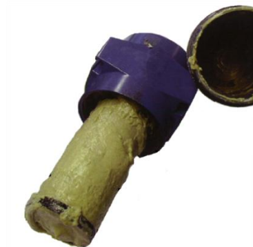
Slika 3. Nataložena nečistoća na površini filterskog uložka
