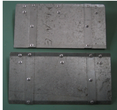
Слика 3.16 Изглед мерне лопатице АТР жалузине типа В, С и D израђене од поцинкованог челичног лима са уздужним ојачањима
