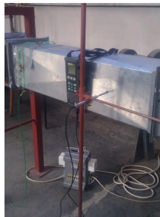
Слика 5.24 Подесиви статив за позиционирање анемометра са топлом жицом
