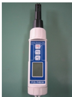
Слика 5.19 Уређај за мерење притиска, температуре и релативне влажности произвођача “PCE”, модел THB38
