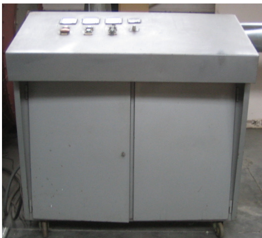
Слика 5.5 Орман тиристорске регулације броја обртаја
