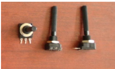
Слика 3.33 Изглед ротационих потенциометара произвођача “Dadaelectronics”, модел “Тусо 10k”
