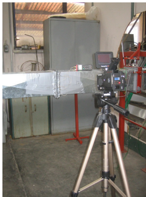
Слика 5.12. Контрола цурења ваздуха на прирубничком споју термовизијском камером произвођача “Wuhan”, модел “ThermoPro™TP8S”
