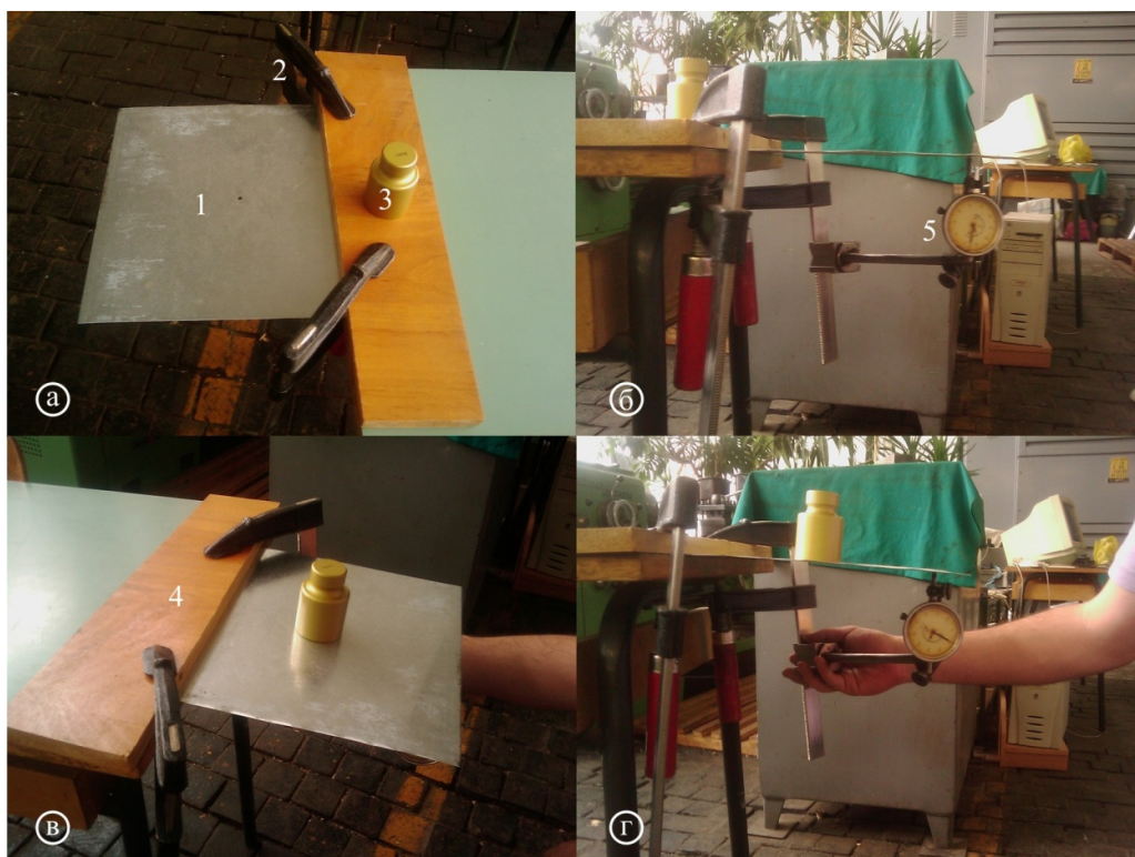
Слика 3.21 Експериментално одређивање максималног угиба укљештене плоче од поцинкованог челичног лима дебљине 0,5 mm
