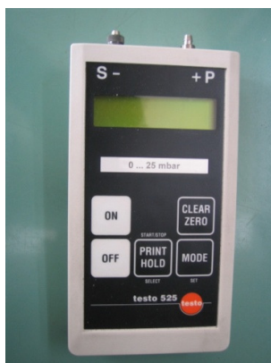
Слика 5.15 Диференцијални манометар произвођача “Testo”, модел 525
