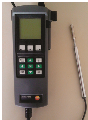
Слика 5.23 Анемометар са топлом жицом произвођача “Testo”, модел 400
