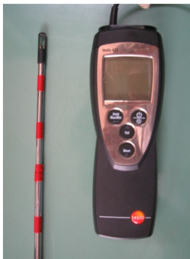
Слика 5.10. Анемометар са топлом жицом произвођача “Testo”, модел 425
