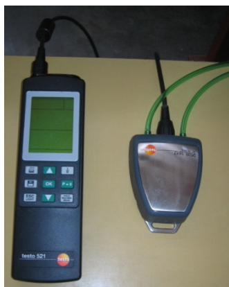
Слика 5.17 Диференцијални манометар произвођача “Testo” модел 521
