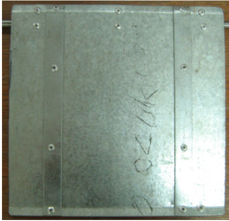
Слика 3.15 Изглед мерне лопатице АТР жалузине типа А израђене од поцинкованог челичног лима са уздужним ојачањима
