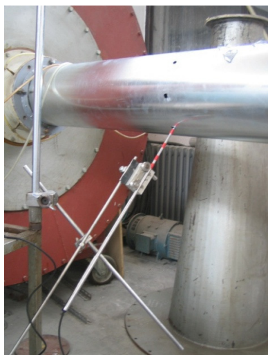
Слика 5.9 Колица са подесивим стативом за позиционирање анемометра са топлом жицом
