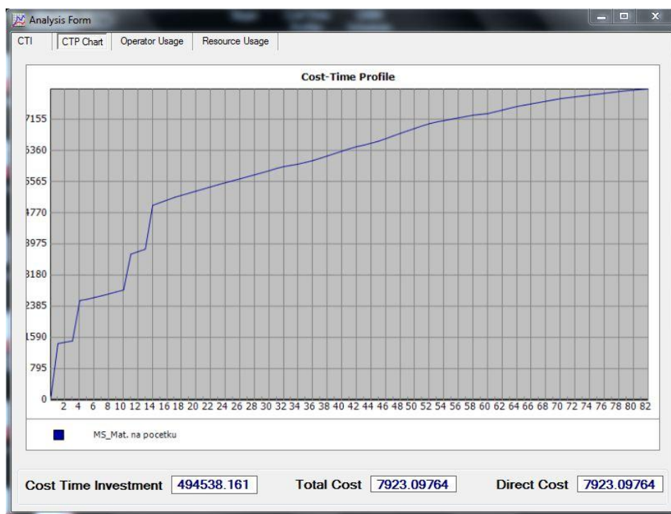
Slika 48. Vremensko-troškovni profil za MS pravilo raspoređivanja i materijal na početku
