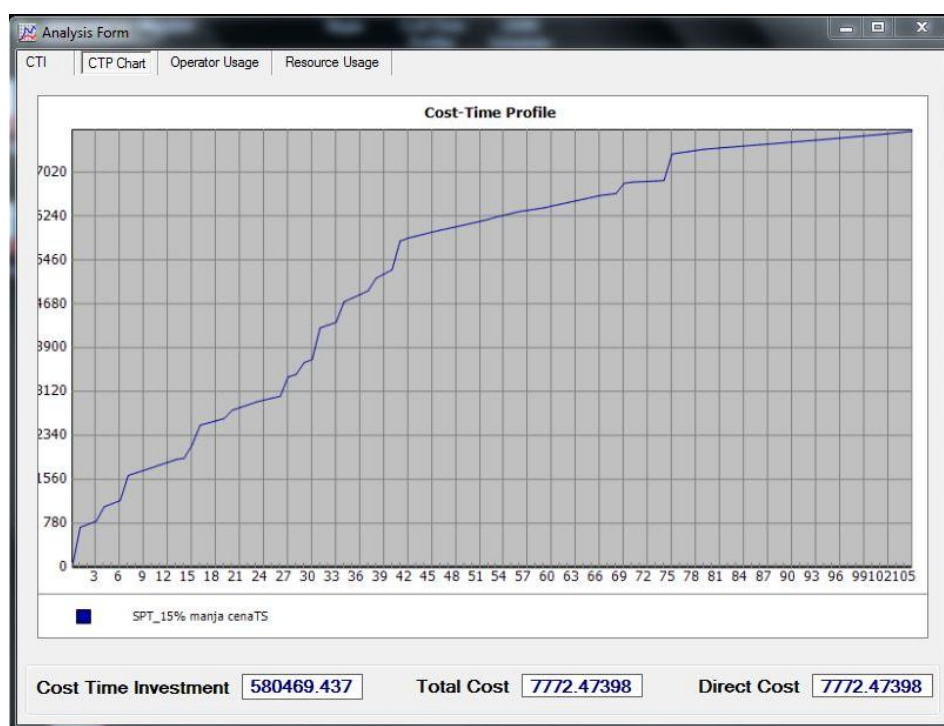
Slika 87. Vremensko-troškovni profil za SPT pravilo raspoređivanja i cena tehnoloških sistema smanjena za 15%
