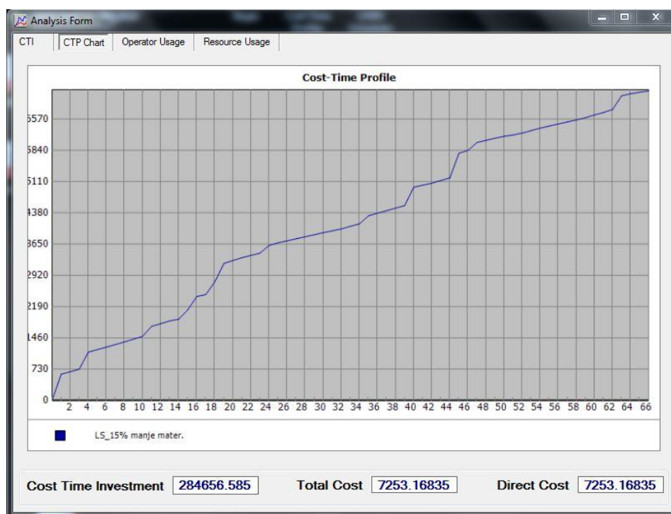
Slika 76. Vremensko-troškovni profil za Local search pravilo raspoređivanja i smanjena cena materijala za 15%
