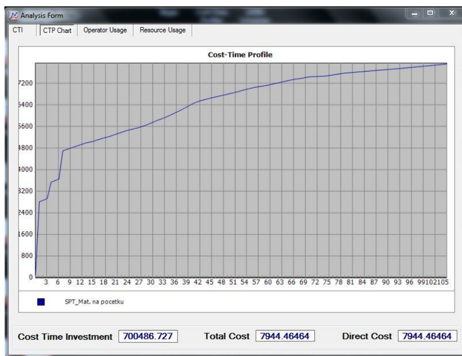
Slika 50. Vremensko-troškovni profil za SPT pravilo raspoređivanja i materijal na početku
