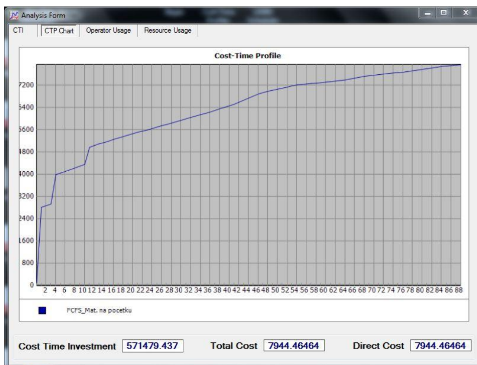
Slika 44. Vremensko-troškovni profil za FCFS pravilo raspoređivanja i materijal na početku
