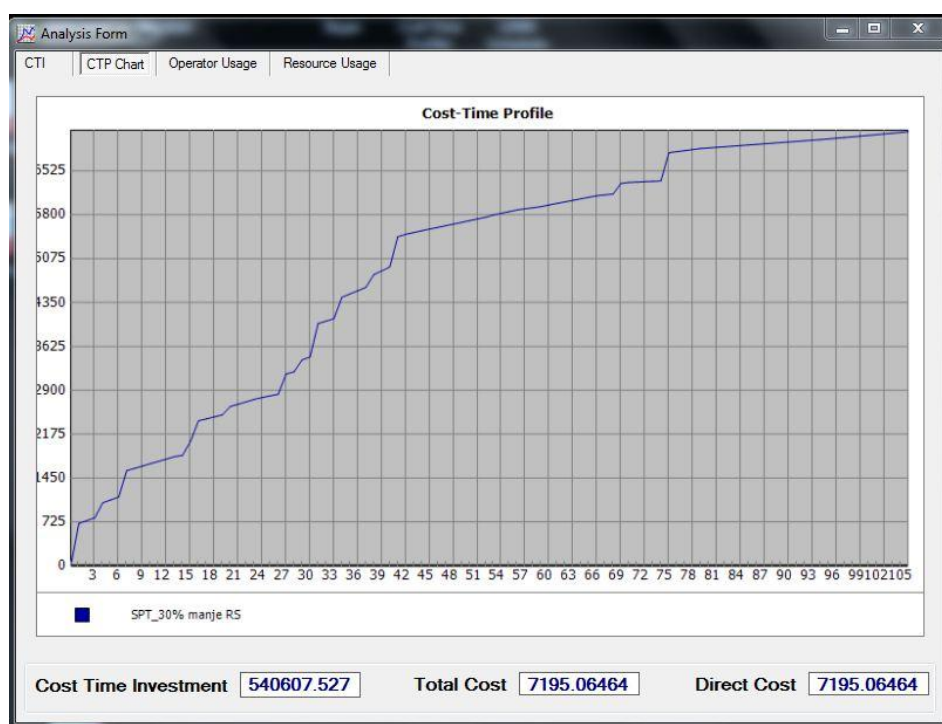
Slika 84. Vremensko-troškovni profil za SPT pravilo raspoređivanja i smanjena cena radnog sata radnika za 30%
