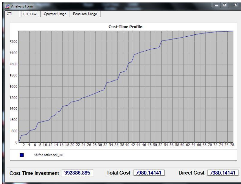
Slika 69. Vremensko-troškovni profil za Shifting Bottleneck/SUM(wT) pravilo raspoređivanja i JIT materijal
