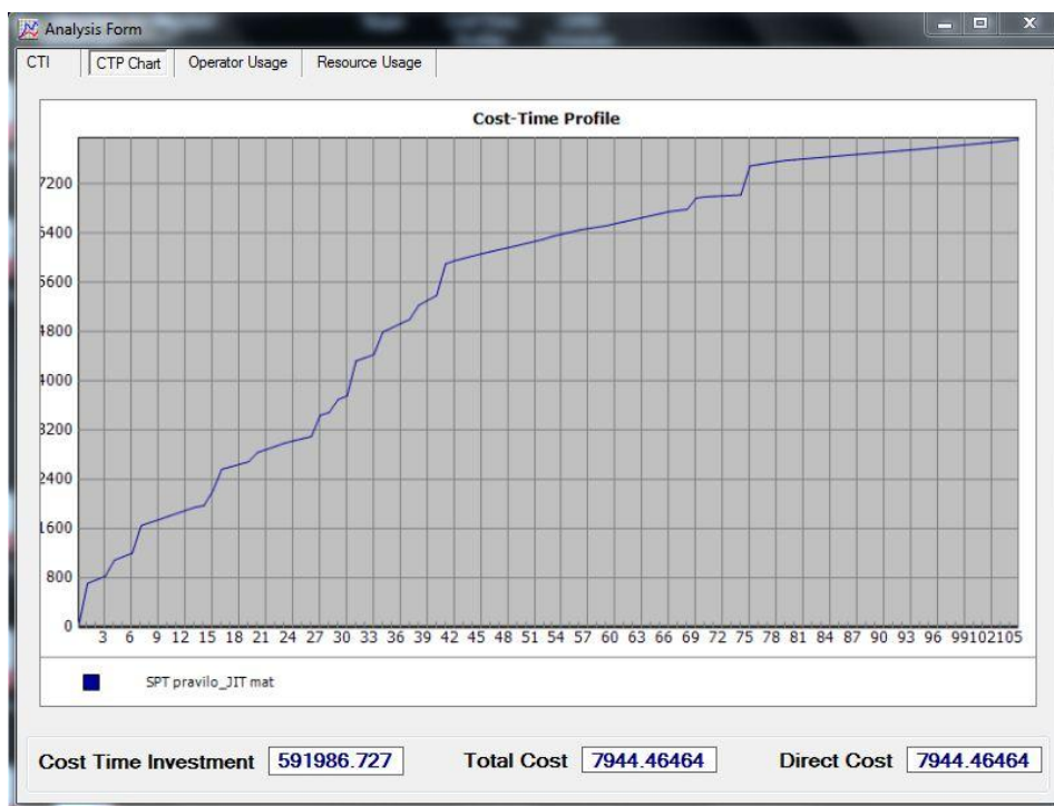
Slika 66. Vremensko-troškovni profil za MS pravilo raspoređivanja i JIT materijal
