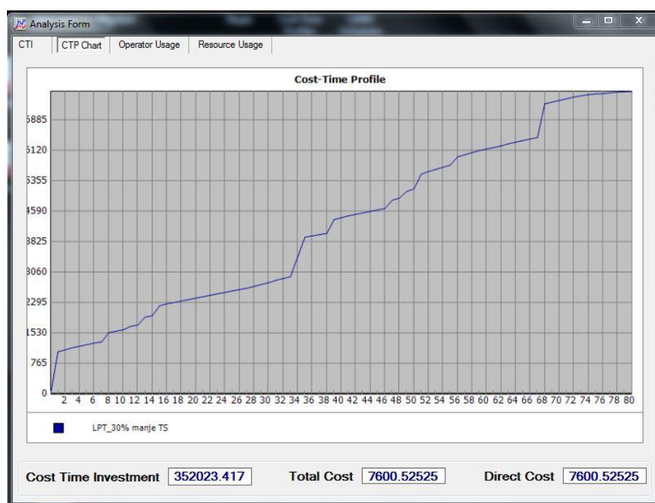
Slika 89. Vremensko-troškovni profil za LPT pravilo raspoređivanja i cena tehnoloških sistema smanjena za 30%
