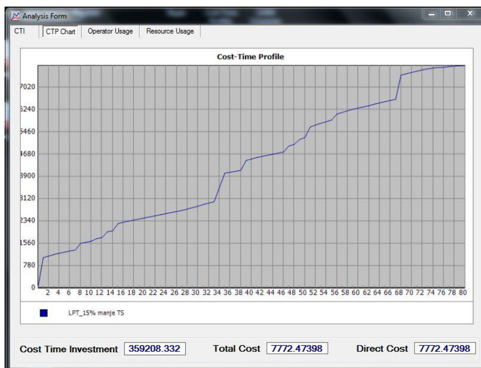
Slika 86. Vremensko-troškovni profil za LPT pravilo raspoređivanja i cena tehnoloških sistema smanjena za 15%
