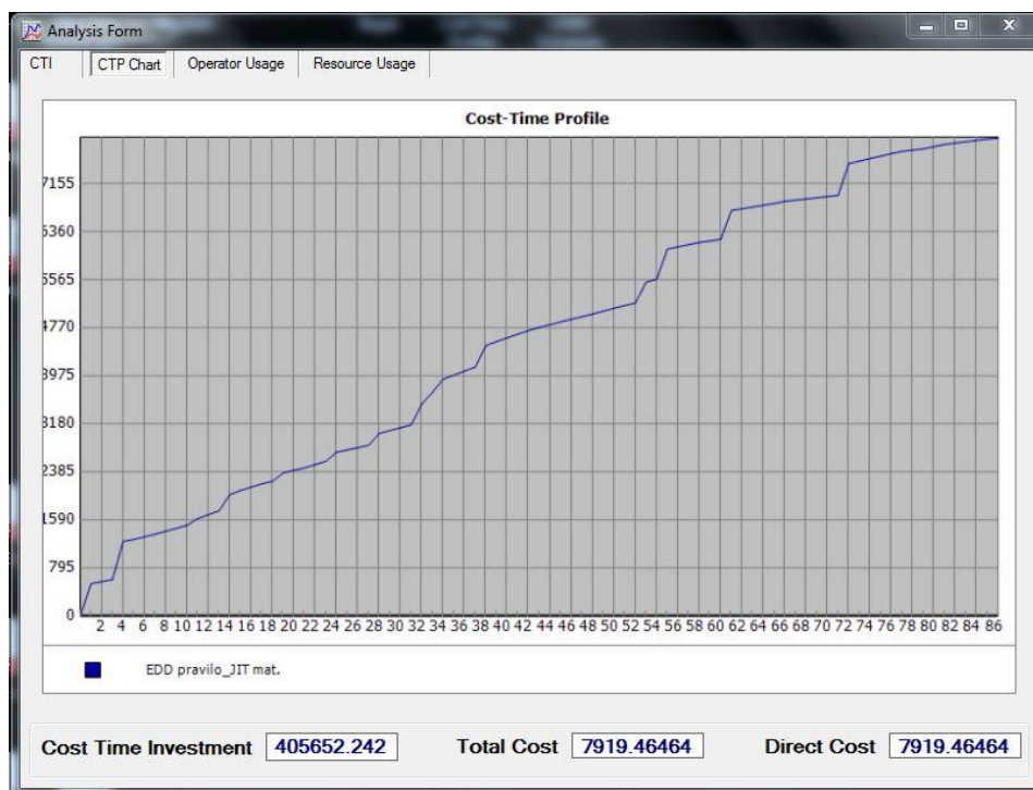
Slika 62. Vremensko-troškovni profil za EDD pravilo raspoređivanja i JIT materijal
