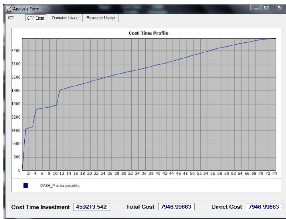
Slika 60. Vremensko-troškovni profil za Shifting bottleneck/Tmax – DASH pravilo raspoređivanja i materijal na početku
