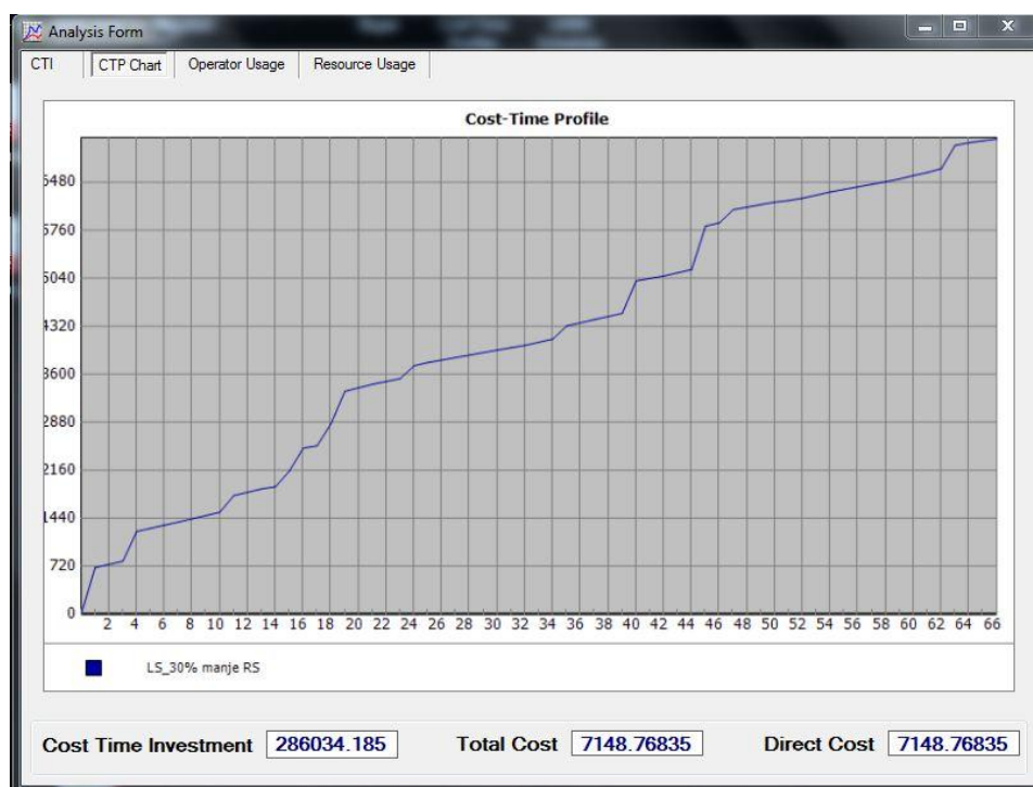
Slika 85. Vremensko-troškovni profil za Local search pravilo raspoređivanja i smanjena cena radnog sata radnika za 30%
