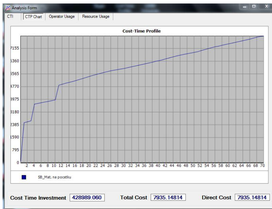
Slika 54. Vremensko-troškovni profil za SB rutine pravilo raspoređivanja i materijal na početku
