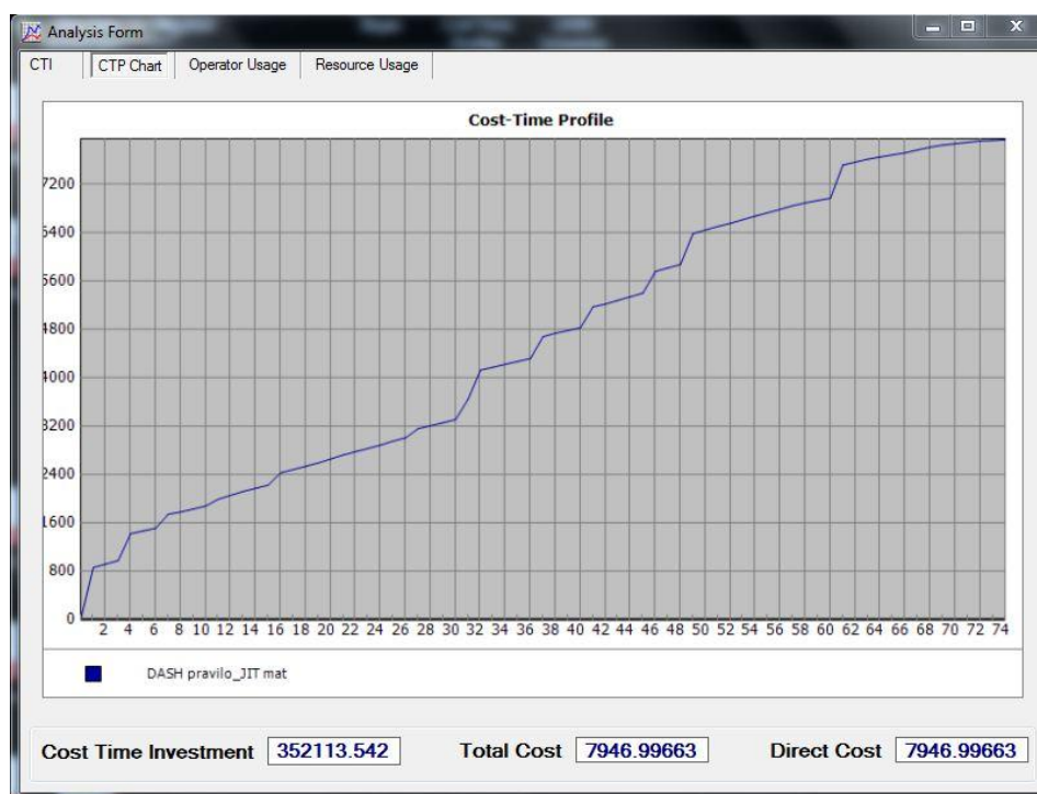
Slika 71. Vremensko-troškovni profil za Shifting Bottleneck- DASH pravilo raspoređivanja i JIT materijal
