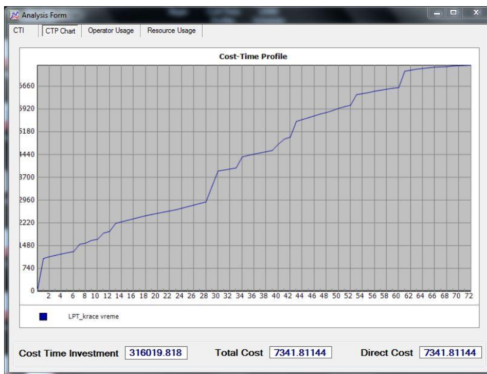
Slika 92. Vremensko-troškovni profil za LPT pravilo raspoređivanja i vreme trajanja svake aktivnosti smanjeno za 1 sat
