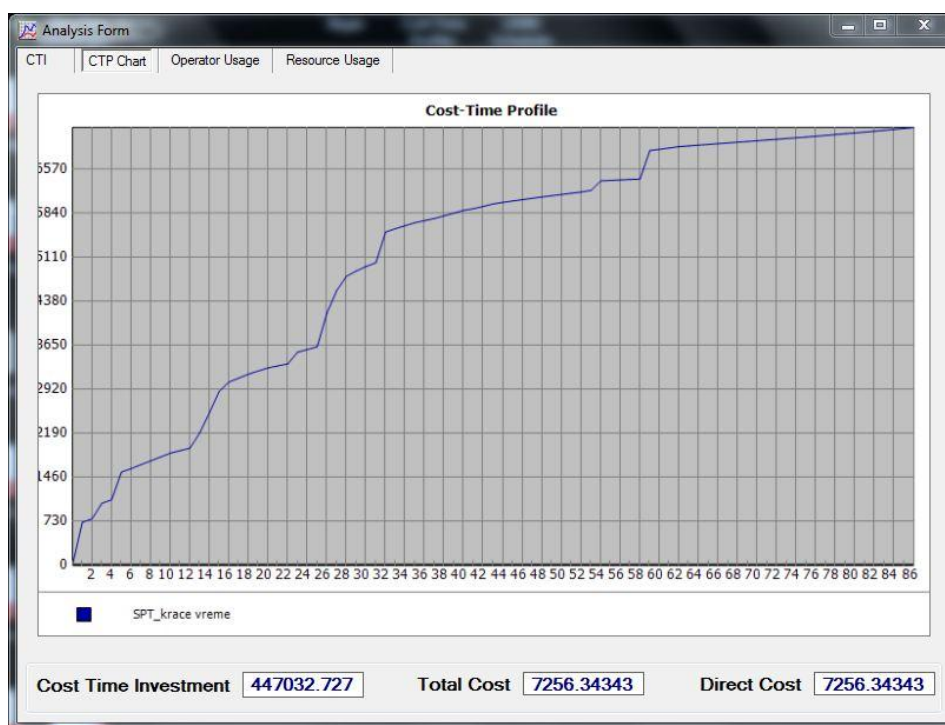
Slika 93. Vremensko-troškovni profil za SPT pravilo raspoređivanja i vreme trajanja svake aktivnosti smanjeno za 1 sat
