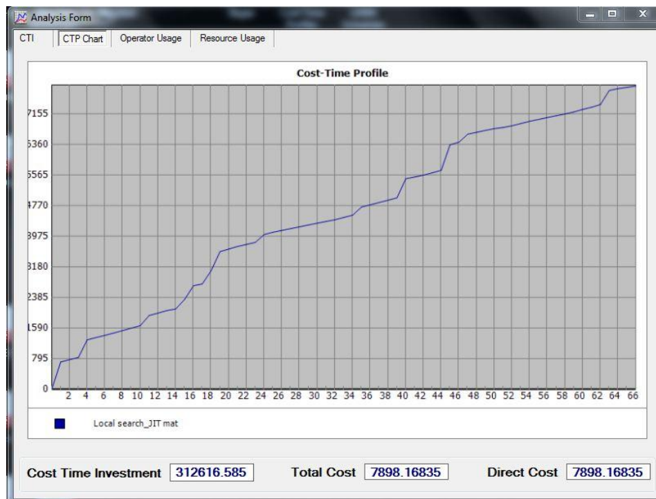
Slika 70. Vremensko-troškovni profil za Local search pravilo raspoređivanja i JIT materijal
