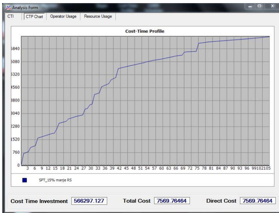
Slika 81. Vremensko-troškovni profil za SPT pravilo raspoređivanja i smanjena cena radnog sata radnika za 15%
