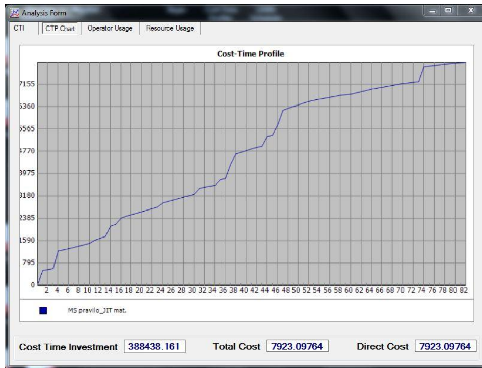
Slika 65. Vremensko-troškovni profil za MS pravilo raspoređivanja i JIT materijal
