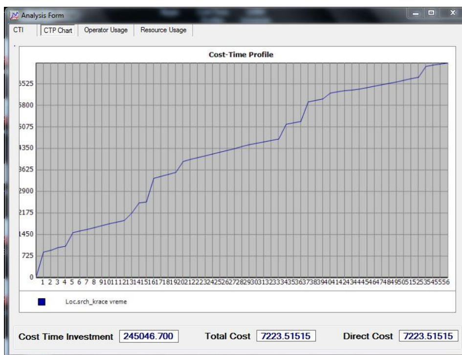
Slika 94. Vremensko-troškovni profil za Local search pravilo raspoređivanja i vreme trajanja svake aktivnosti smanjeno za 1 sat
