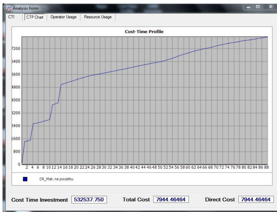
Slika 40. Vremensko-troškovni profil za CR pravilo raspoređivanja i ulazak materijala na početku procesa
