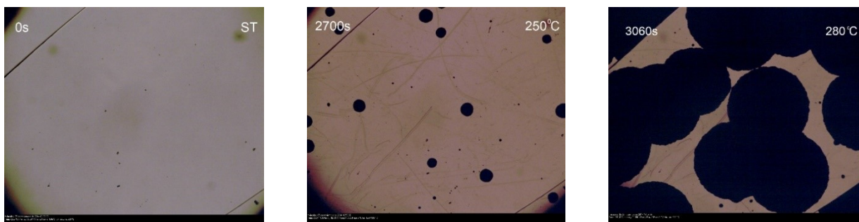
Slika 38. Promene optičkih svojstava uzorka C datim na sobnoj temperaturi t=0 s, posle 2700 s na T=250 °C i posle 3060 s na T=280 °C
