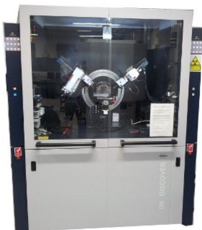
Slika 10. Bruker D8 difraktometar sa malim upadnim uglom
