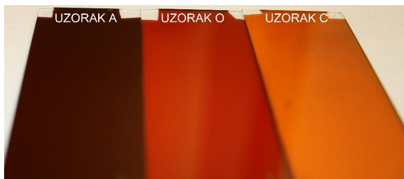
Slika 29. Prikaz različitih boja uzoraka usled aniliraja- uzorak A nakon sinteze pre aniliranja, uzorak O posle prvog koraka, uzorak C posle oba koraka aniliranja na T=220\text{ }^{\circ}\text{C} i 290\text{ }^{\circ}\text{C}
