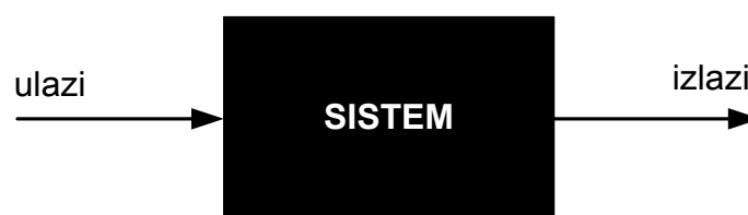
Slika 7.1. Prilikom testiranja metodologijom crne kutije definišu se ulazi u sistem i posmatraju izlazi, ne ulazeći u internu strukturu sistema
