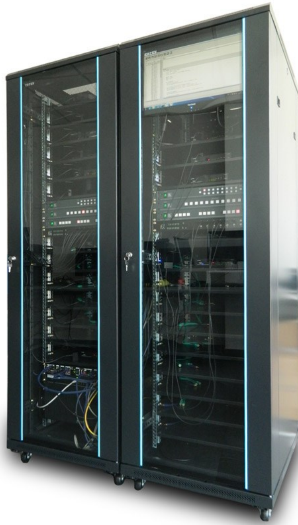
Slika 2.4. Sistem za automatsku proveru 24 prijemnika TV signala odjednom
