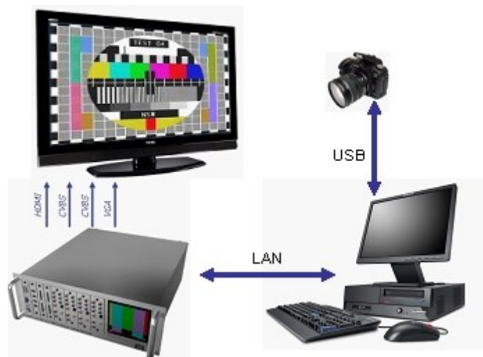
Slika 5.1. Pregled sistema za automatsku proveru rada digitalnih TV prijemnika sa stanovišta percepcije korisnika
