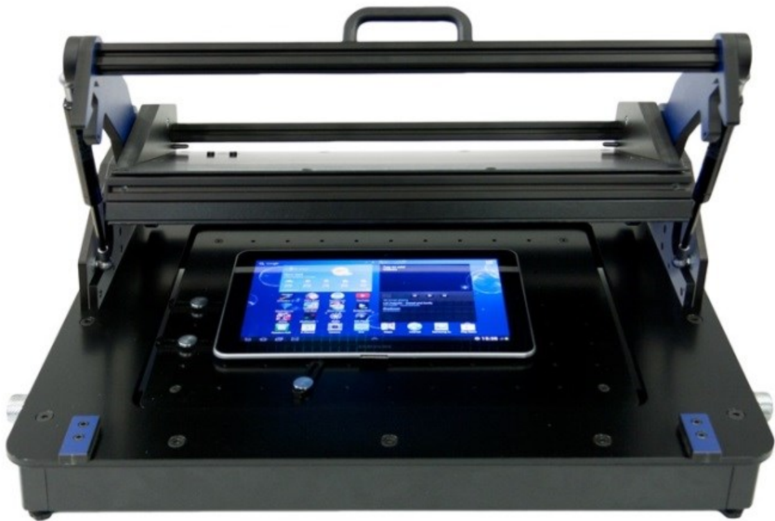
Slika 8.1. Uređaj sa stimulacionom pločom kao deo BBT sistema za proveru rada uređaja sa ekranom osetljivim na dodir
