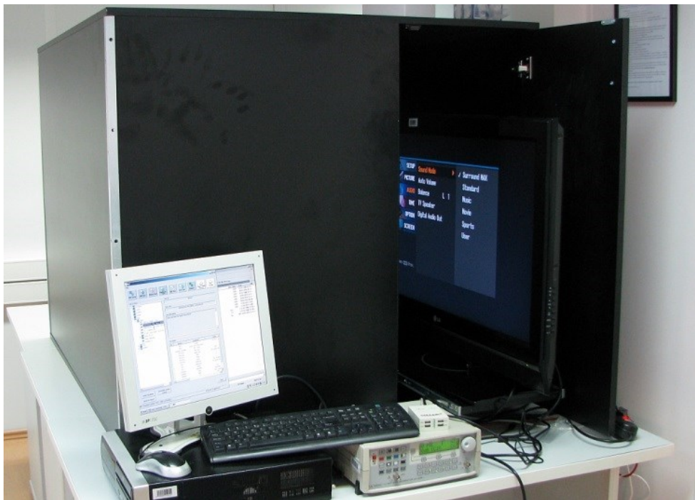
Slika 5.2. „Crna komora“ za automatsku proveru TV prijemnika sa stanovišta percepcije korisnika omogućava konstantno svetlosno okruženje tokom provere
