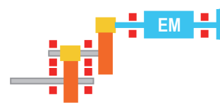
б) Редуктор са излазним зупчаником између лежајева, а другим на препусту
