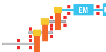
а) Редуктор са излазним зупчаником на препусту, а четвртим и петим између лежајева
