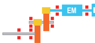
а) Редуктор са излазним зупчаником на препусту, а другим и трећим између лежајева
