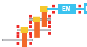
в) Редуктор са излазним зупчаником између лежајева и петим зупчастим вратилом ослоњеним на три лежаја
