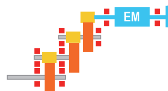
б) Редуктор са излазним зупчаником између лежајева, а четвртим на препусту
