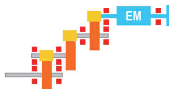
д) Редуктор са излазним зупчаником између лежајева, а трећим и четвртим на препусту
