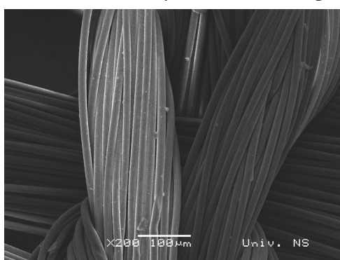
Slika P 3.3.10. Mikroskopski snimak uzorka odštampalog sa pet nanosa boje - materijal 2: a) nakon izlaganja procesu pranja (200 x uvećanje), b) nakon izlaganja procesu pranja (2000 x uvećanje)
